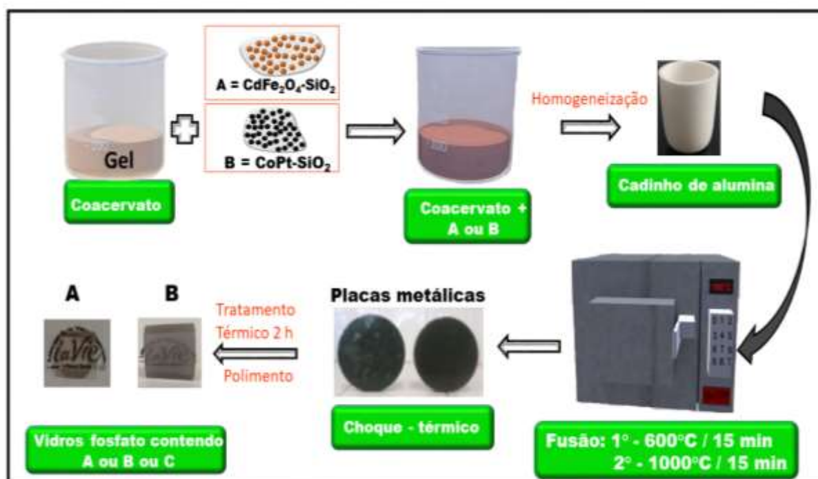
Figura 33. Esquema da preparação dos VFs contendo nanopartículas recobertas com sílica.
