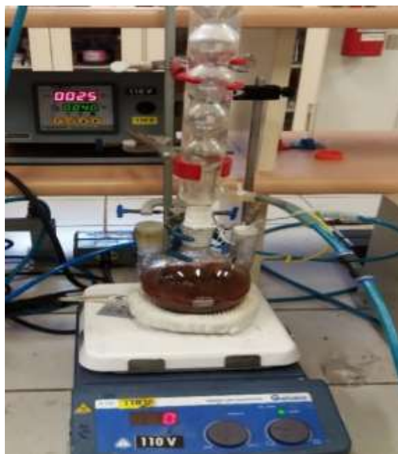
Figura 25. Aparato experimental utilizado na obtenção de nanopartículas de \text{CdFe}_2\text{O}_4 .
