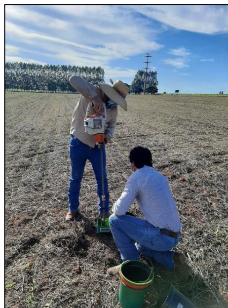
Figura 7 - Coleta de amostras de solo para caracterização da área e semeadura
