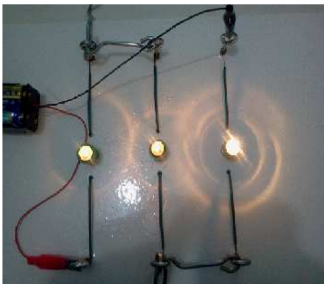
Figura 23 – Experimento presencial de circuito elétrico (ligação em série)
