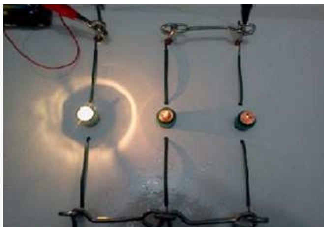
Figura 25 – Experimento presencial de circuito elétrico (ligação mista)
