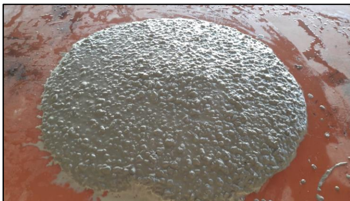
Figura 42 - Ensaio de espalhamento para o concreto autoadensável
