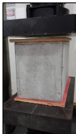
Figura 33 - Regularização das superfícies do bloco
