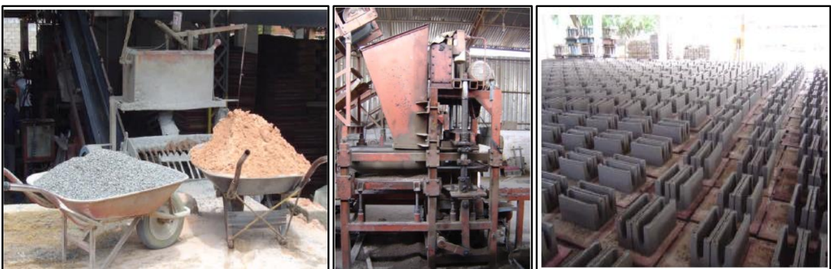
Figura 4 - Fabricação dos blocos vazados de concreto com baixa tecnologia
