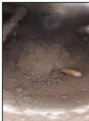
Figura 24 - Mistura de concreto com \alpha = 63\%
