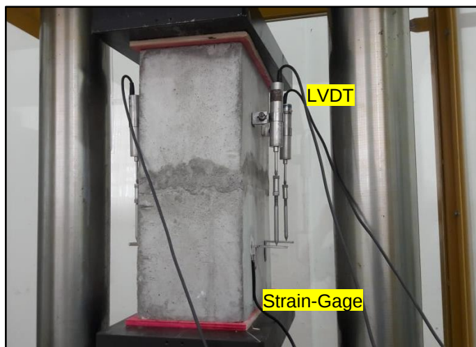
Figura 22 - Prisma instrumentado com LVDTs e extensômetros (Strain-Gages)
