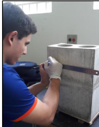
Figura 38 - Marcações para o posicionamento dos extensômetros e LVDTs
