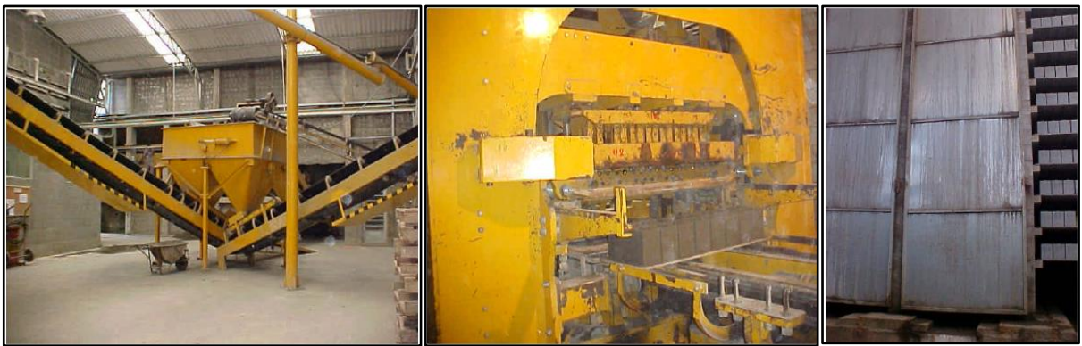
Figura 3 - Fabricação dos blocos vazados de concreto com alta tecnologia
