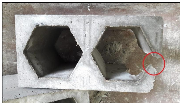
Figura 47 - Desprendimento do concreto do bloco GH-2
