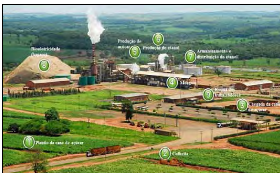
Figura 3 - Esquema de uma usina de açúcar e álcool.
