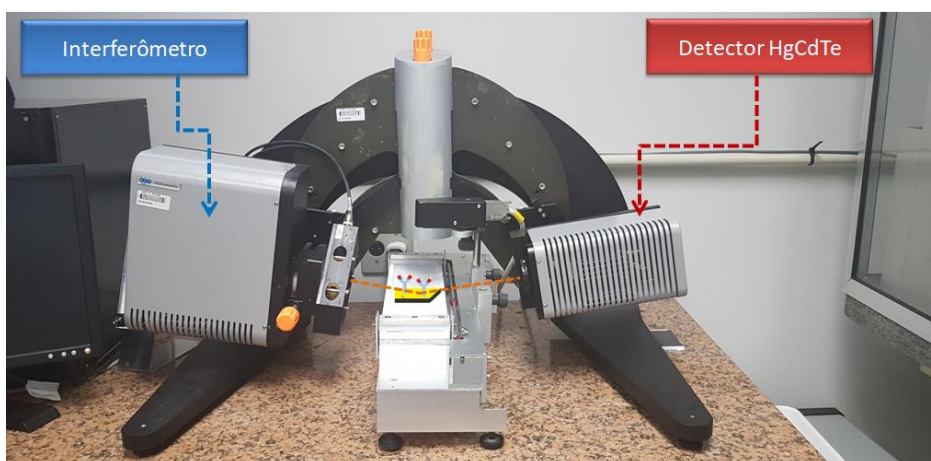
Figura 8. Espectrofotômetro PM IRRAS composto por um modulador fotoelástico de cristal ZnSe e uma fonte de luz infravermelha que é refletida pelo substrato metálico para o fotodetector HgCdTe.
