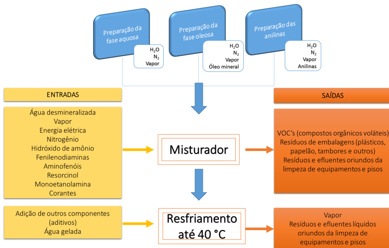
Figura 1 – Fluxograma básico do processo de produção de tinturas de cabelo
