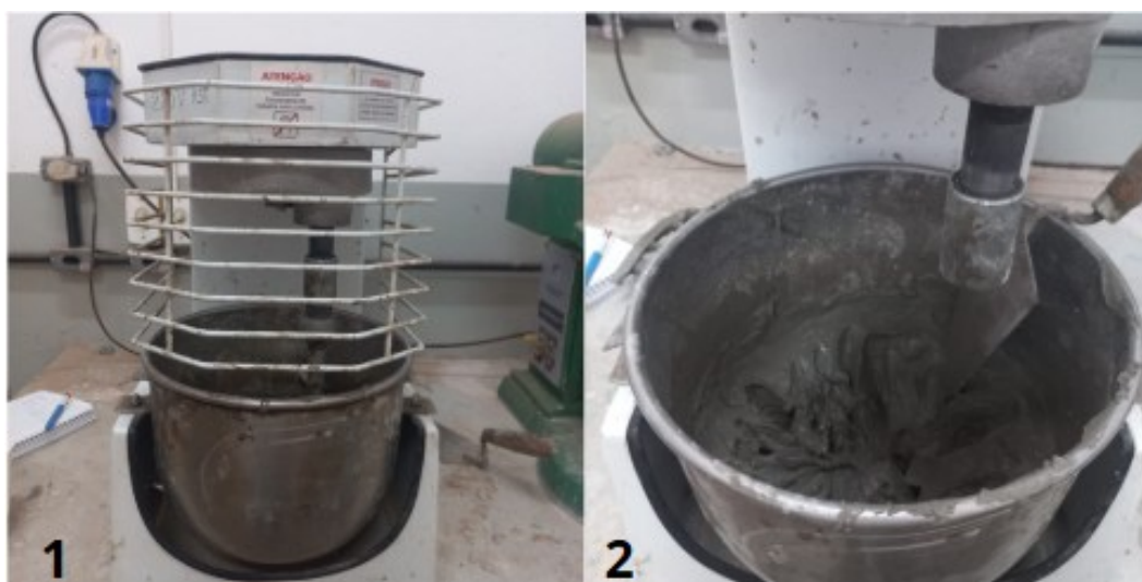
Figura 11. Fotografia digital da argamassadeira utilizada [1] e da pasta de cimento após o preparo [2]
