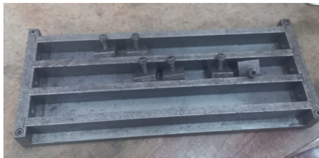
Figura 16. Fotografia digital das fôrmas usadas no teste de retração
