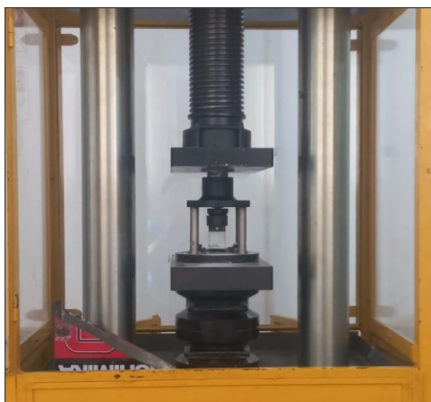
Figura 20. Fotografia digital do equipamento Emic® DL30000N realizando o ensaio de compressão.
