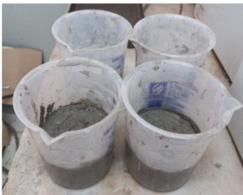
Figura 14. Fotografia digital da pasta de cimento em processo de medição da exsudação
