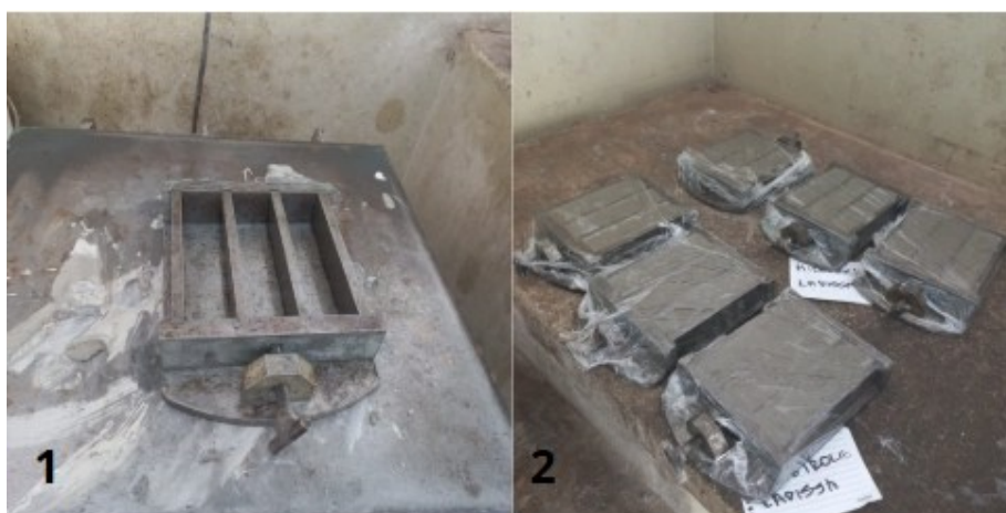
Figura 19. Fotografia digital das fôrmas lubrificadas [1] e corpos de prova em processo de cura [2].
