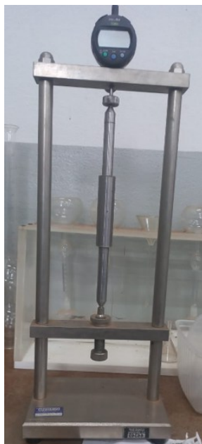
Figura 15. Fotografia digital do aparelho relógio comparador mecânico vertical usado para a medição de retração
