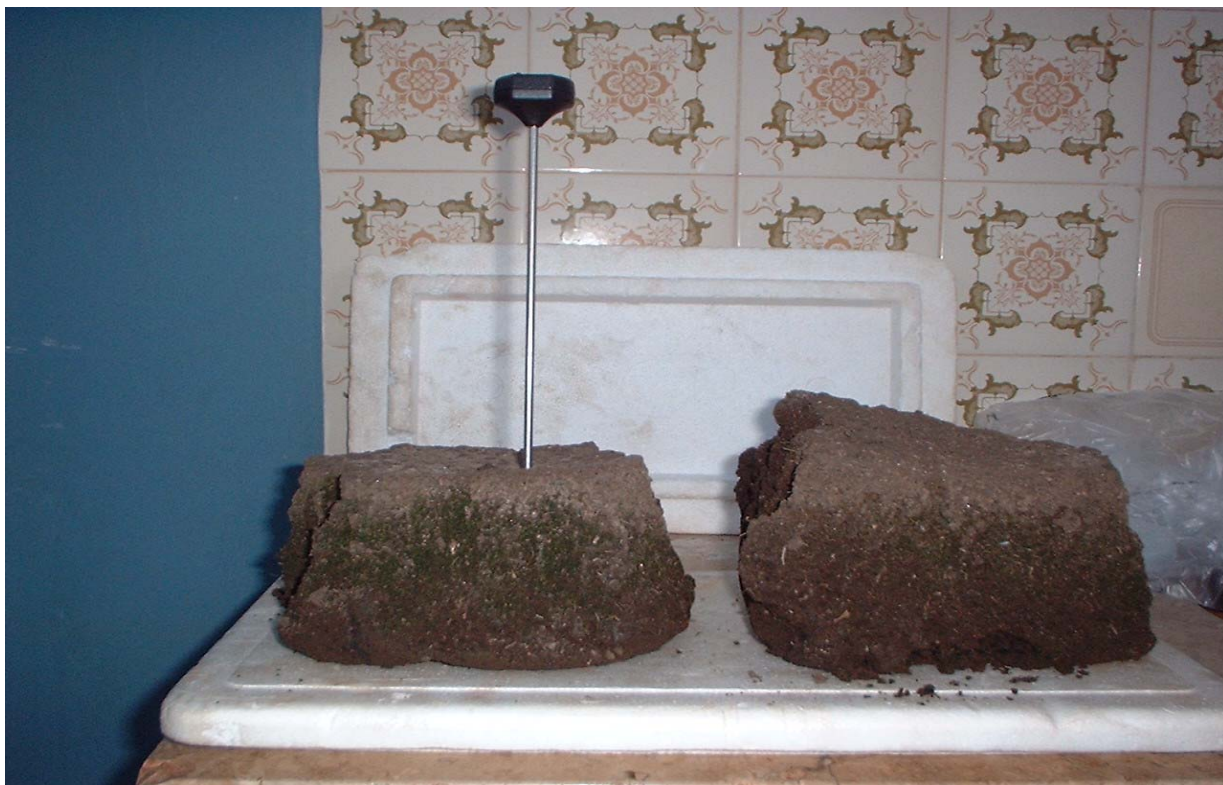
Figura 6 – Medição da temperatura do lodo de esgoto seco colhido aos 30 dias de secagem
