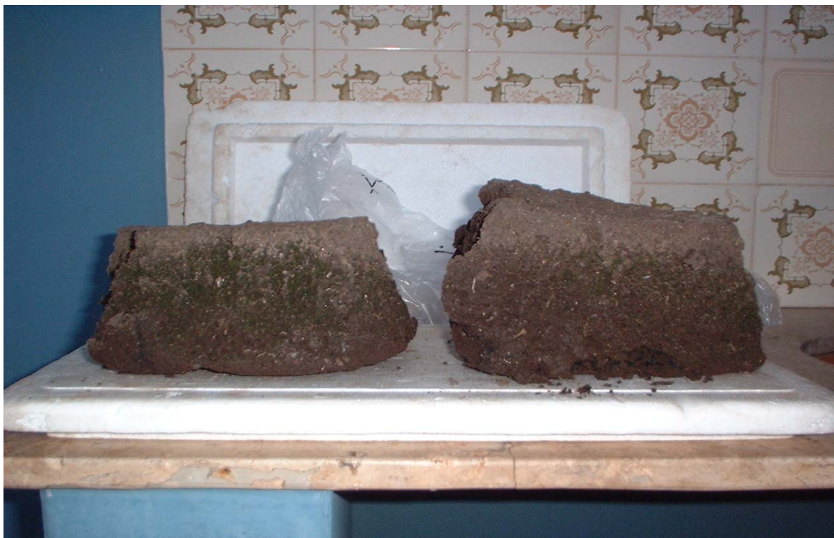
Figura 5 – Lodo de esgoto seco colhido aos 30 dias de secagem na caixa de decantação da Estação de Tratamento de Esgoto (ETE), unidade Aero Rancho, Águas Guariroba, Campo Grande - MS
