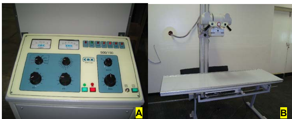
Figura 1. Unidade radiológica fixa do Setor de Radiologia Veterinária do Hospital Veterinário “Luiz Quintiliano de Oliveira”, do Curso de Medicina Veterinária – UNESP, campus de Araçatuba, utilizada nos exames de radiográficos: marca CRX – modelo SHF 730 – 500 mA / 150 kVp / tempo de exposição de 0,05 a 5 segundos (s) (A) e equipado com grade antidifusora Potter-Bucky (B). (Araçatuba – SP, 2009)
