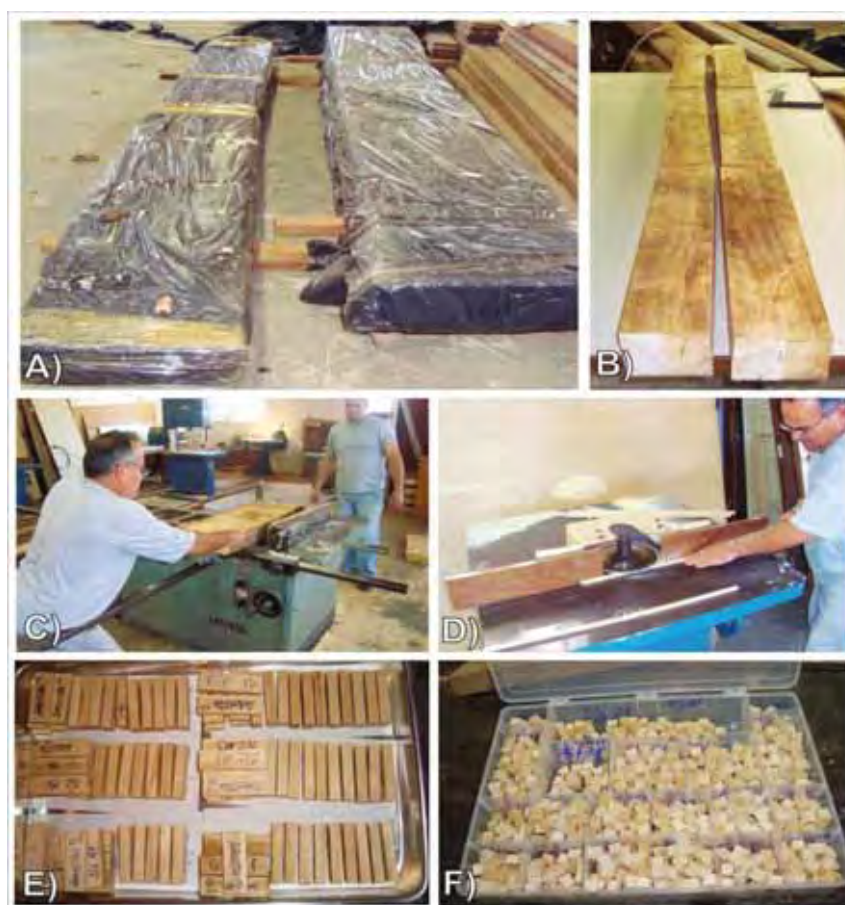
Figura 6. A) Prancha central empacotada com lona plástica após o desdobro na serraria em Poloni-SP; B) Prancha central desdobrada ao meio e subdividida em três seções; C) e D) Processamento e confecção dos corpos de prova em suas respectivas regiões e orientações; E) corpos de prova separados e numerados para o ensaio de ASTM 4445 (2003) e IPT (1980) e E) corpos de provas para o ensaio anatômico e velocidade de penetração fungo manchador.
