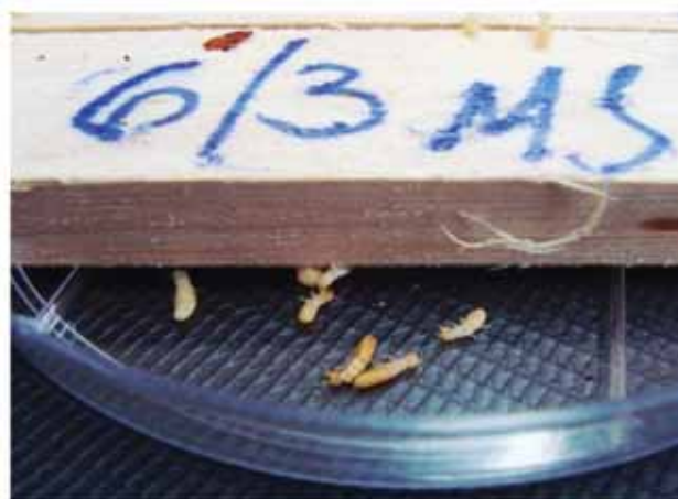
Figura 29. Cryptotermes brevis (Isoptera : Kalotermitidae) intoxicação após a terceira hora do início do experimento a exposição aos corpos de prova tratados.
