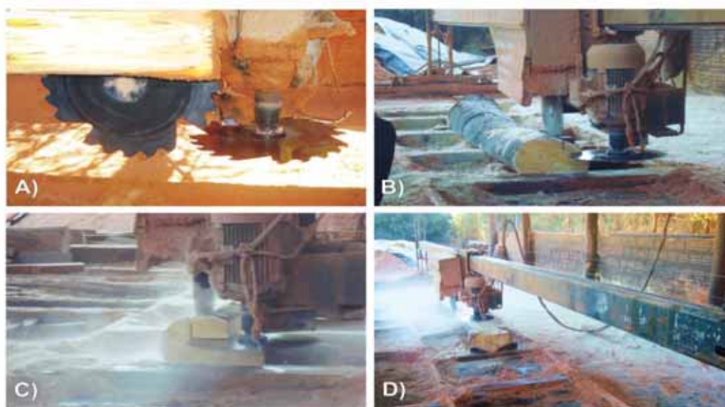
Figura 4. A) Serra de disco duplo utilizada no desdobro das toras; B) Detalhe do alinhamento e orientação do pranchão central; C) Retirada das costaneira e D) Detalhamento na finalização do pranchão central das toras de Hevea brasiliensis .
