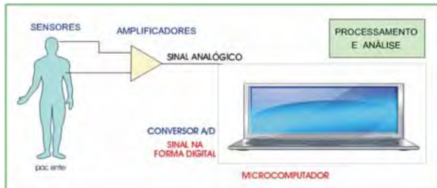
Figura 3 - Diagrama representativo de um sistema de aquisição de sinal biológico (AMORIM, 2002)
