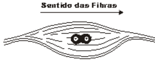
Figura 2 - Diagrama representativo da colocação de eletrodos de superfície em relação ao sentido das fibras musculares (Amorim, 2002).
