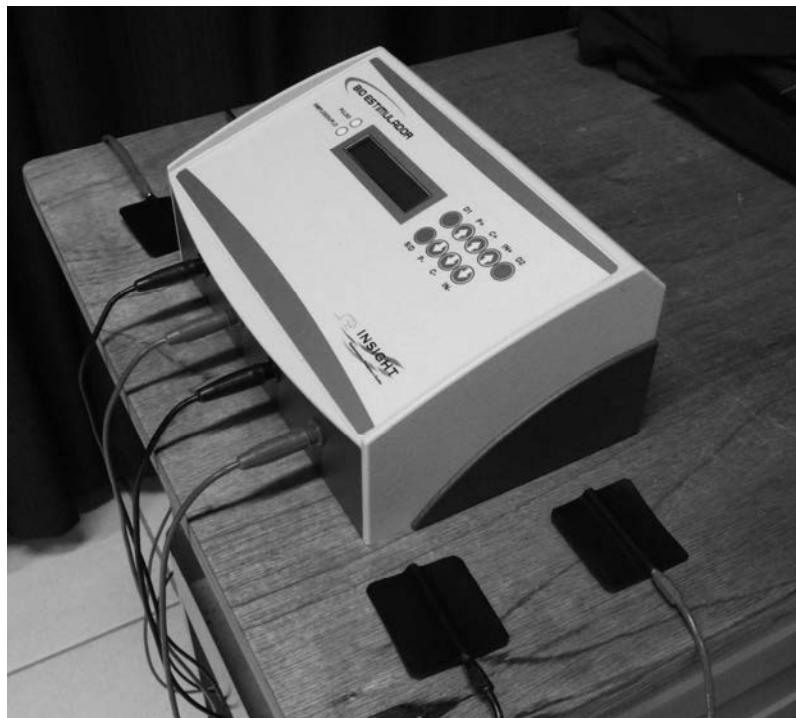
Figura 4.6. Protótipo Bioestimulador (Insight®, Ribeirão Preto – Brasil) e eletrodos de borracha condutiva.
