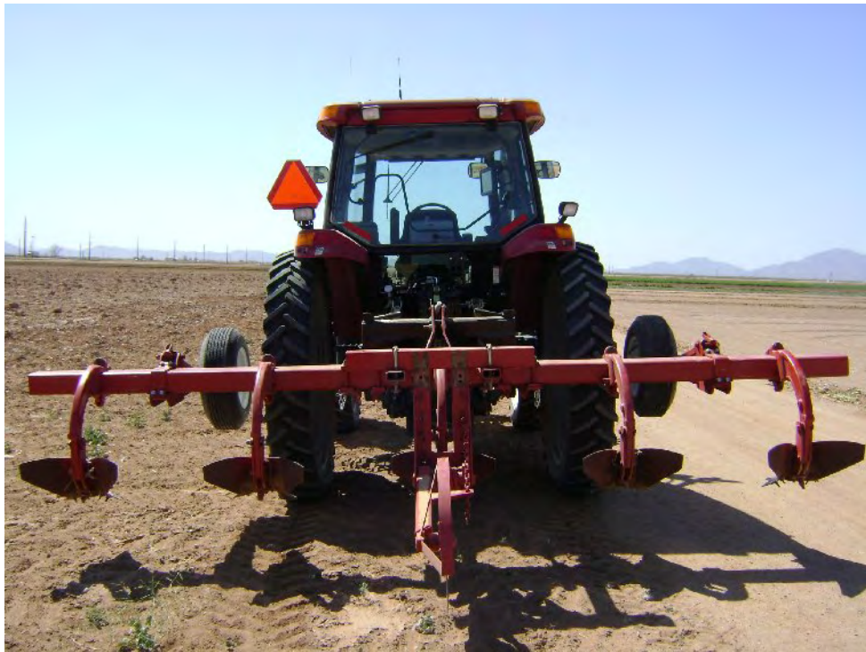
Figura 18. Trator com equipamento arado duplo.
