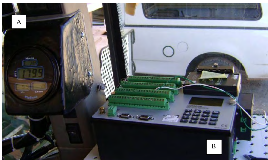
Figura 17. Sistema de aquisição de dados (B) e painel digital (A).
