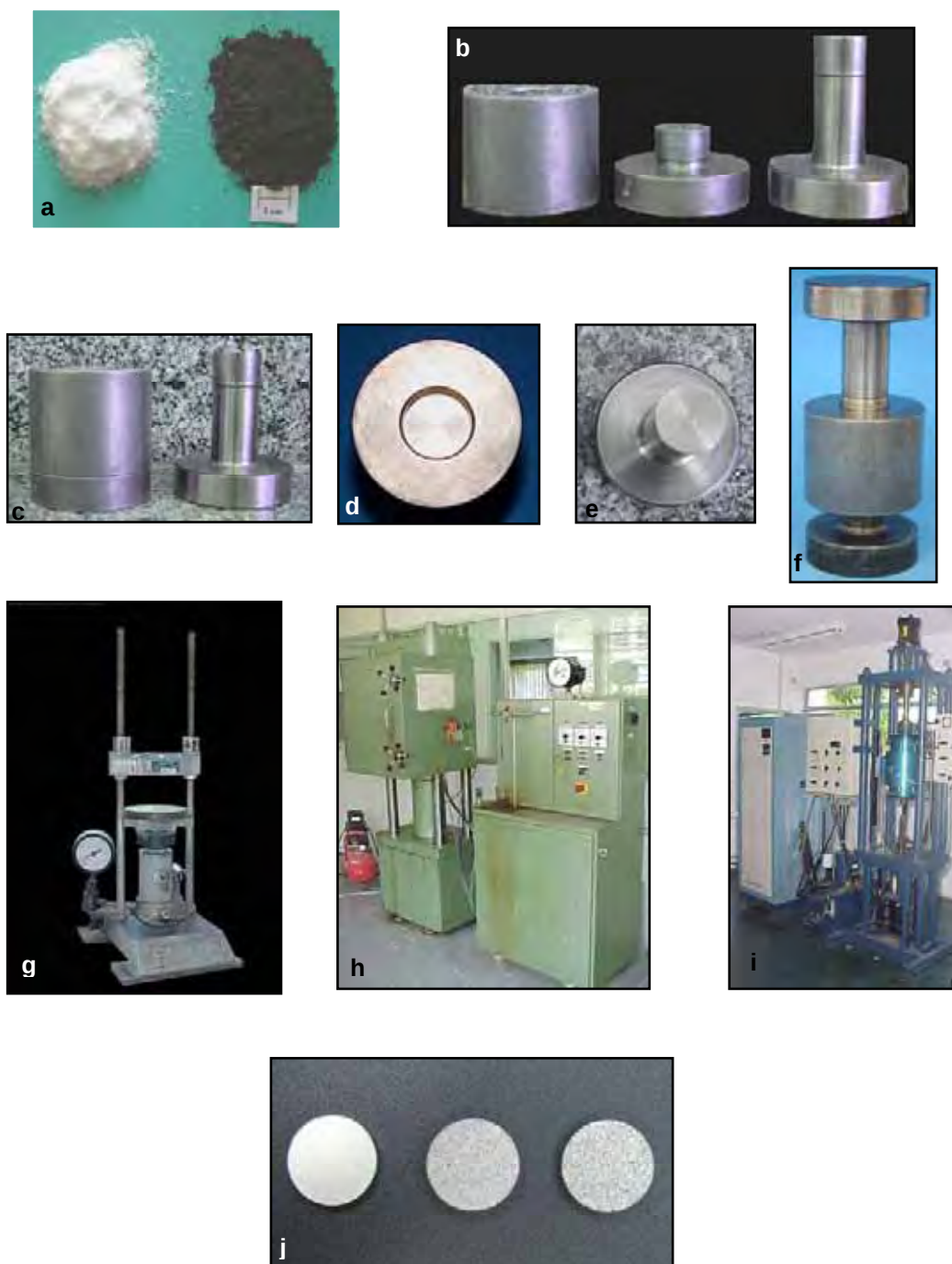
Figura 1 - Procedimentos de confecção das amostras: a) pó de titânio e uréia em grânulos; b-f) matriz idealizada para a confecção dos implantes; g) prensa uniaxial; h) prensa isostática; i) forno a vácuo – Thermal Technology, modelo ASTRO; j) amostras com diferentes porosidades (grupos 1, 2 e 3).
