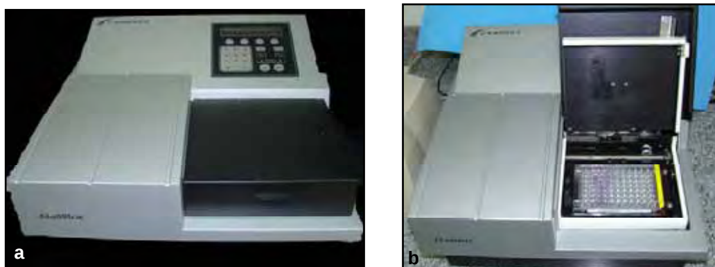
Figura 4 – MTT : a) espectrofotômetro (Cambrex ELx808cse); b) placa de 96 poços, contendo as alíquotas para leitura, acondicionada no equipamento.
