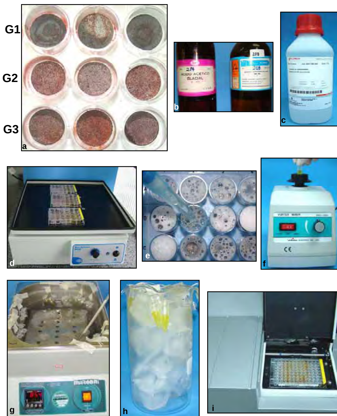
Figura 7 – Nódulos de mineralização: a) placa contendo amostras coradas com vermelho Alizarina; b) ácido acético e cloreto de amônio; c) óleo mineral Sigma; d) mesa agitadora; e) agitação manual com pipeta, para remoção de corante; f-h) sequência de processamento dos reagentes; i) placa de 96 poços, contendo as alíquotas para leitura, acondicionada no espectrofotômetro.
