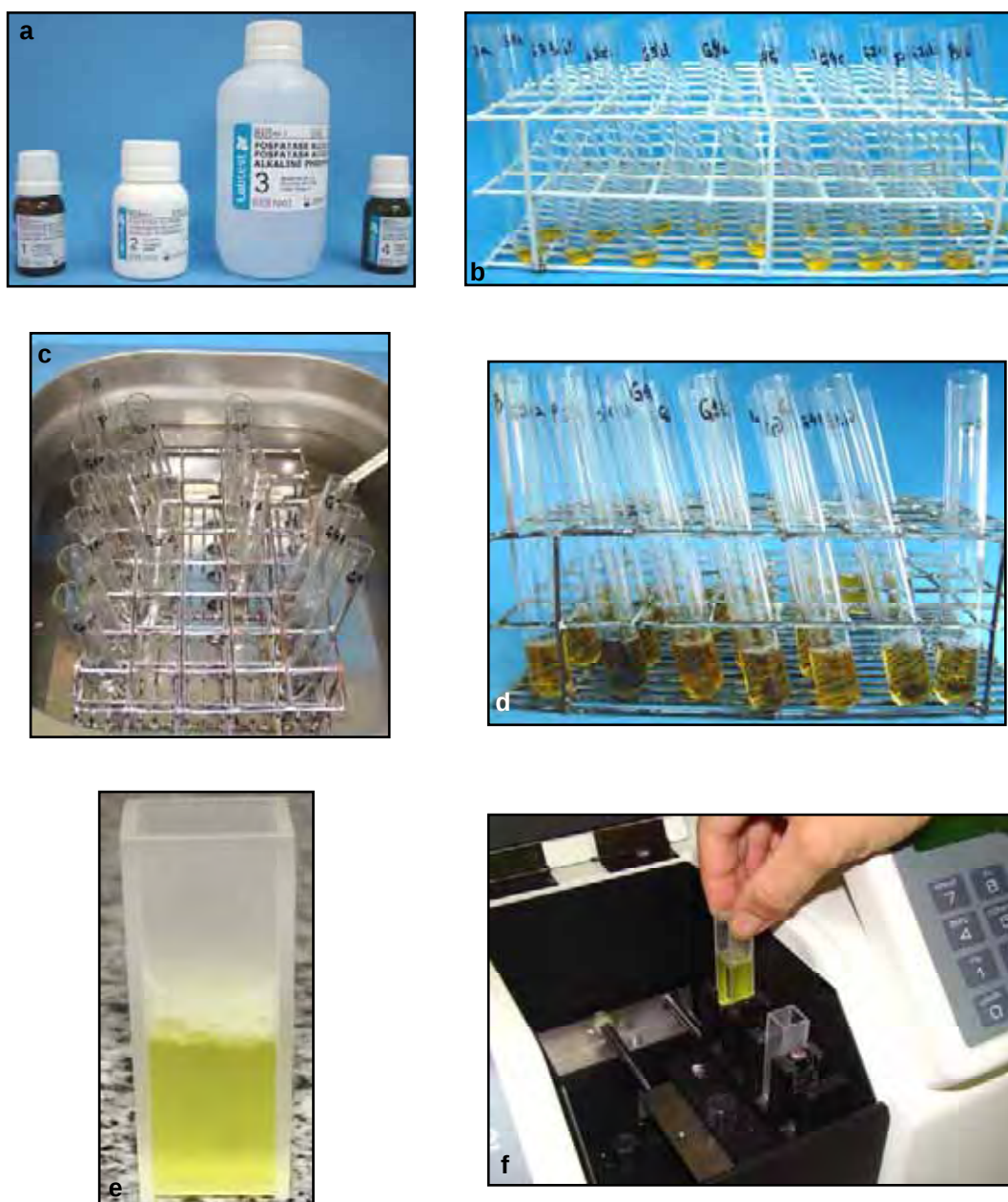
Figura 6 – ALP : a) reagentes para ALP – Kit comercial Labtest; b) tubos de ensaio contendo os reagentes; c) reagentes em banho-maria a 37°C; d) tubos de ensaio contendo os reagentes e alíquotas das amostras; e) alíquota acondicionada em cubeta para leitura; f) espectrofotômetro para leitura das absorbâncias no comprimento de onda de 590nm.
