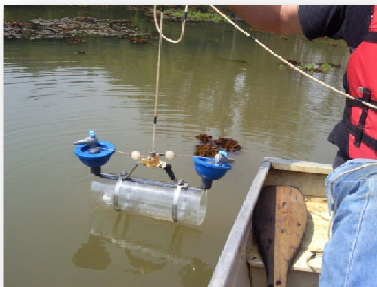
Figura 12 - Procedimento de amostragem utilizando garrafa do tipo Van Dorn.
