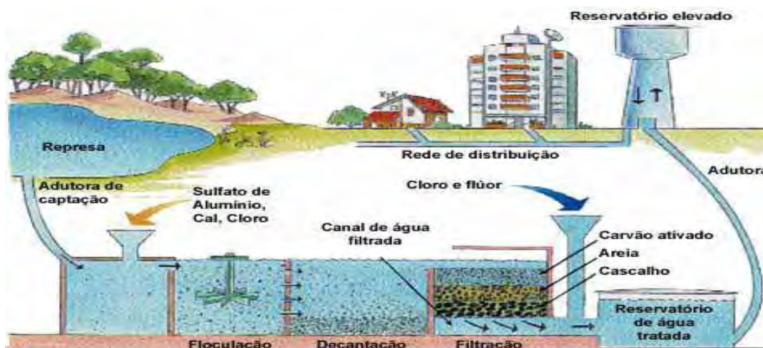
Figura 1 – Esquema Geral do Processo de Tratamento de Água realizado nas ETAs.
