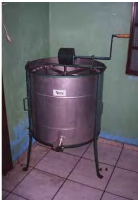
Foto 12: Centrífuga para beneficiar o mel, única tecnologia utilizada no processo produtivo.
