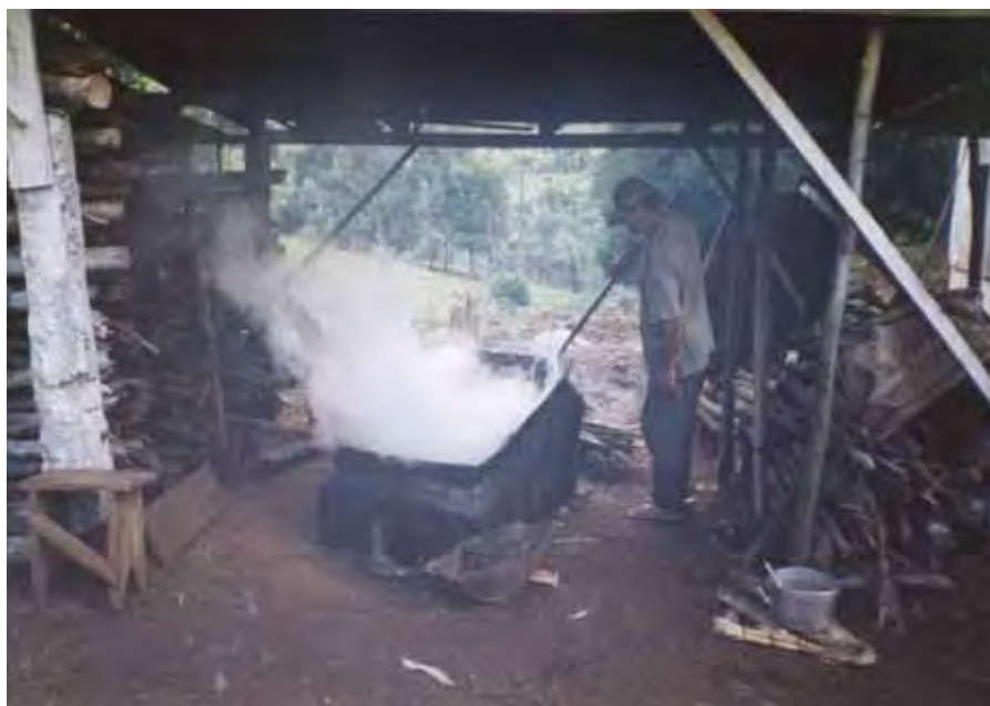
Foto 14: Ivo Matiolo fazendo o açúcar mascavo. Em destaque, o tacho artesanal aquecido a lenha. O melado, que depois de “apurado” transforma-se em açúcar mascavo é mexido com uma pá artesanal adaptada.
