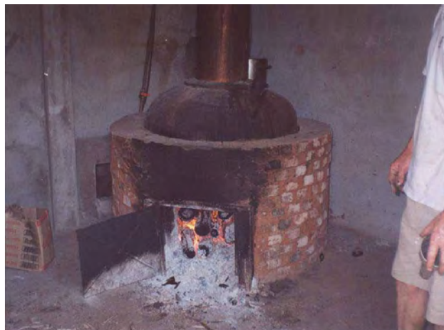
Foto 25: Aquecedor a lenha utilizado por Grezgozeski na produção da cachaça. Fonte: trabalho de campo realizado em 2007.
