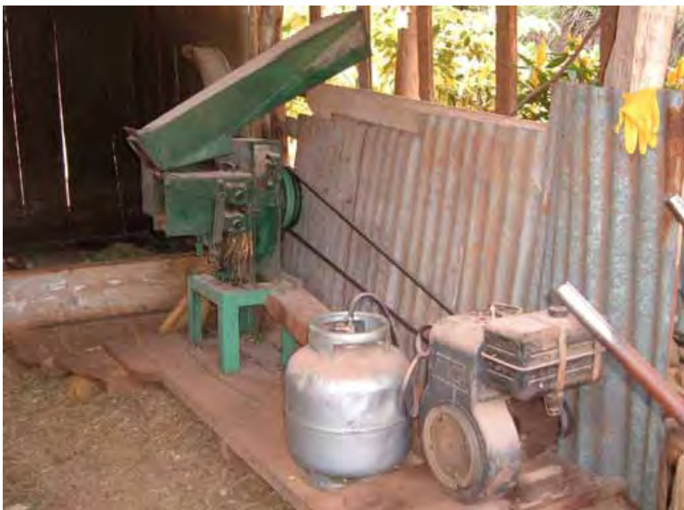
Foto 20: Tecnologia artesanal adaptada com a finalidade de triturar o alimento para o rebanho. Fonte: trabalho de Campo realizado em 2007.
