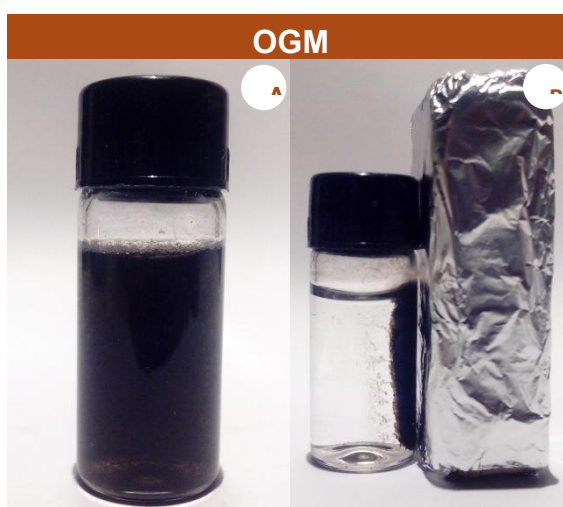
Figura 17 - Dispersão coloidal de OGM em H 2 O/NH 4 OH (pH=9) A) sem e B) com campo magnético
