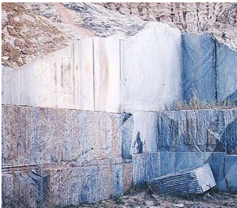
Figura 35 - Lavra de granito em bancada alta
