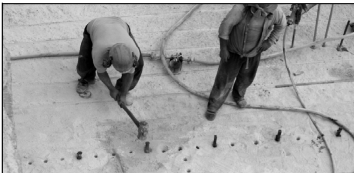
Figura 40 - Método de separação da rocha utilizando cunhas metálicas
