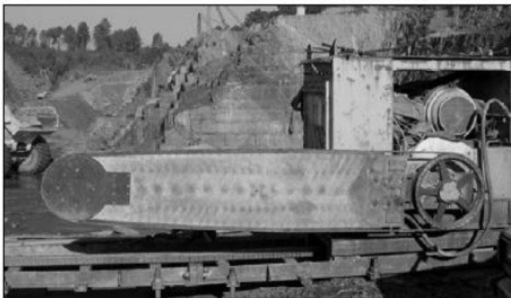
Figura 44 - Cortadeira à corrente diamantada
