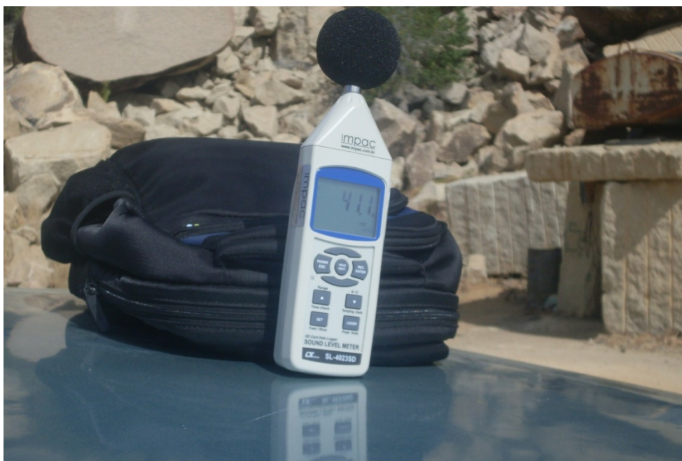
Figura 50 - Decibelímetro utilizado na mensuração de ruídos produzidos na exploração de granito
