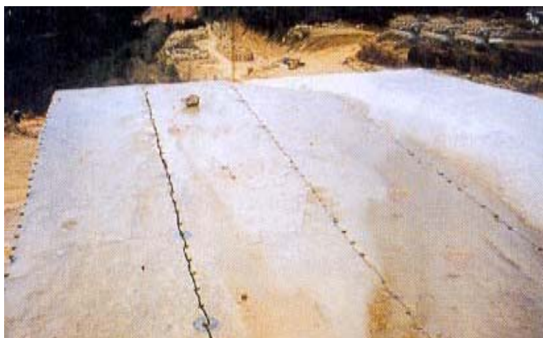
Figura 42 - Corte em granito utilizando massa expansiva
