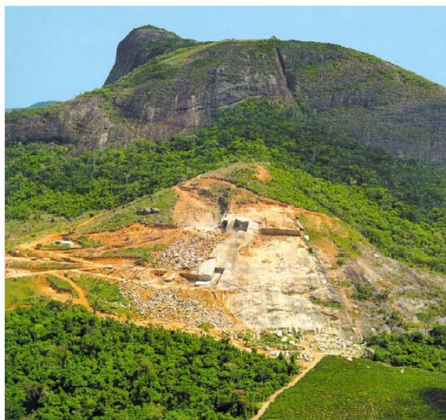
Figura 36 - Foto de lavra por desabamento. Granito “Giallo Speranza”- ES
