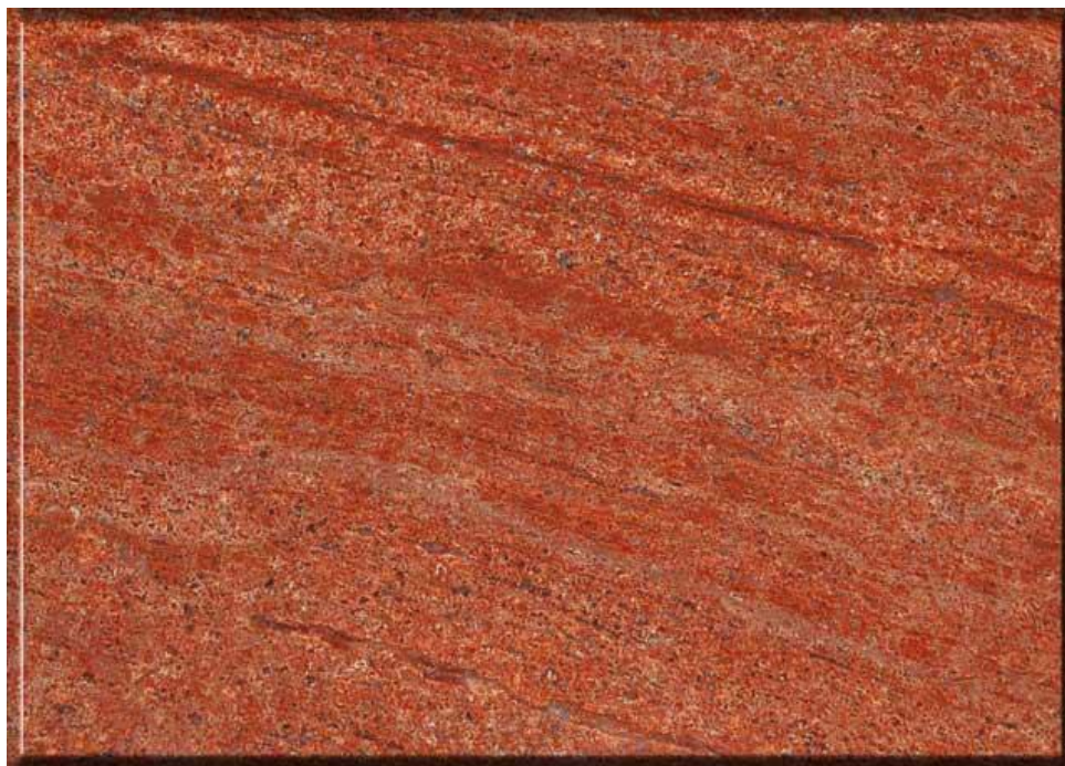
Figura 31 - Ladrilho do granito Magma, apresentando matriz fina, minerais movimentados
