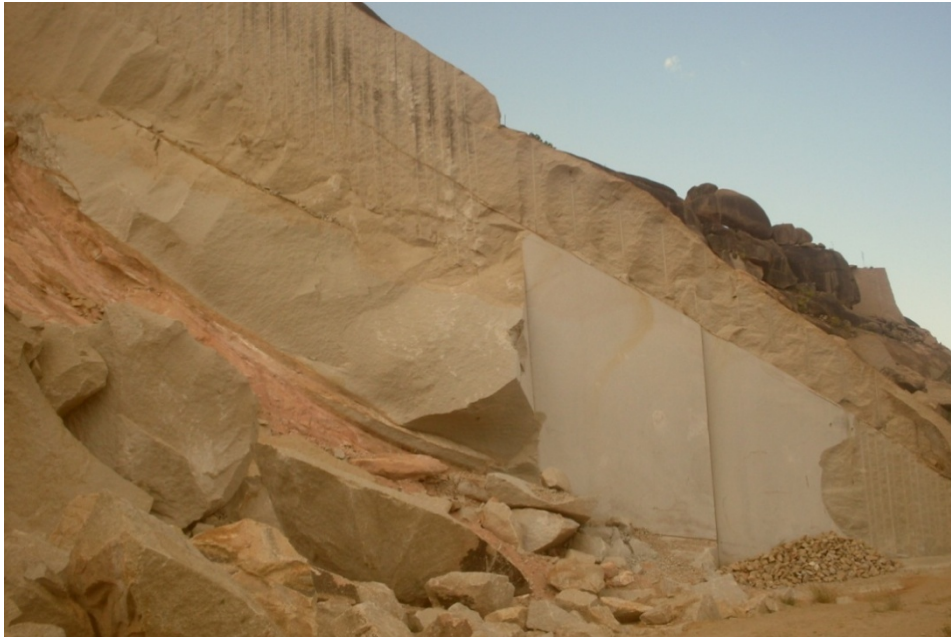
Figura 63 - Frente de lavra sem cobertura vegetal, mostrando matacões sobrepostos em maciço
