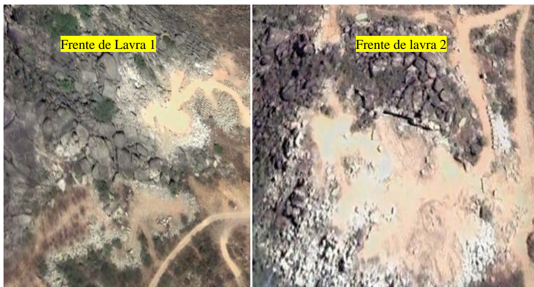
Figura 65 - Imagem de satélite mostrando a disposição aleatória do rejeito e blocos com imperfeições na pedreira de granito Juparaná Gold
