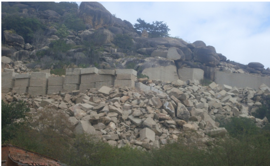
Figura 68 - Blocos com dimensões exigidas pelo mercado, mas que são descartados por apresentarem alguma imperfeição
