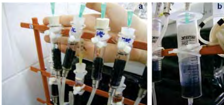
Figura 13. Filtros de carvão confeccionados para os ensaios de remoção de fármacos (a), com detalhamento de sua estrutura (b).
