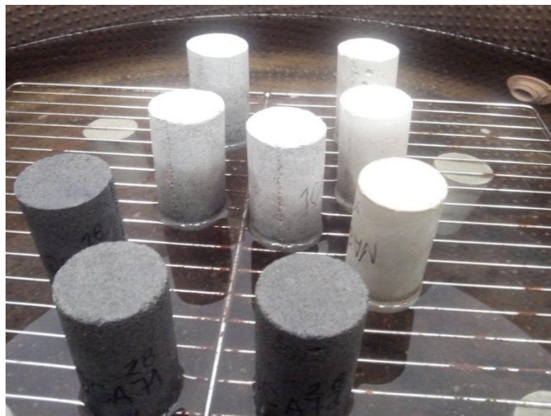
Figura 7- Corpos de prova posicionados para o ensaio de absorção de água por capilaridade
