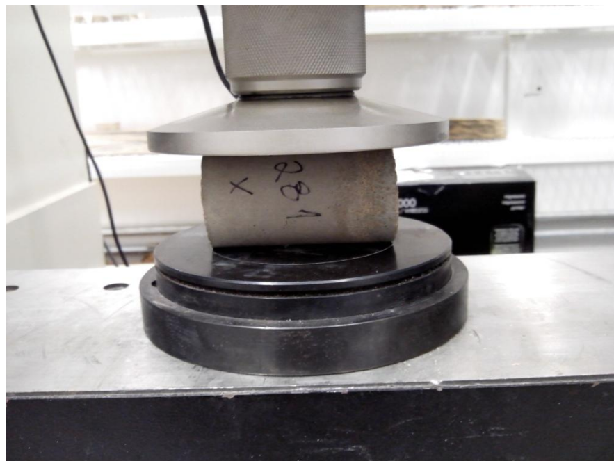
Figura 8 – Aparato montado para o ensaio de compressão diametral
