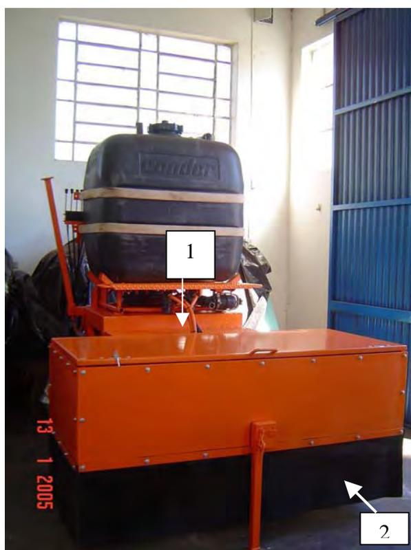
Figura 12. 1- Proteção metálica ao redor, na parte inferior e superior às barras de pulverização; 2 - Proteção de borracha.
