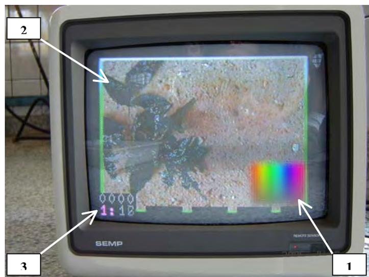
Figura 20: Calibração do sistema: 1 – palheta de cores; 2 – planta daninha pigmentada de preto em função da calibração do espectro de cor verde; 3 – porcentagem de detecção da cor calibrada.
