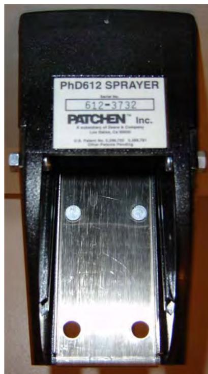
Figura 31. Orifícios que permitem a fixação do sensor.
