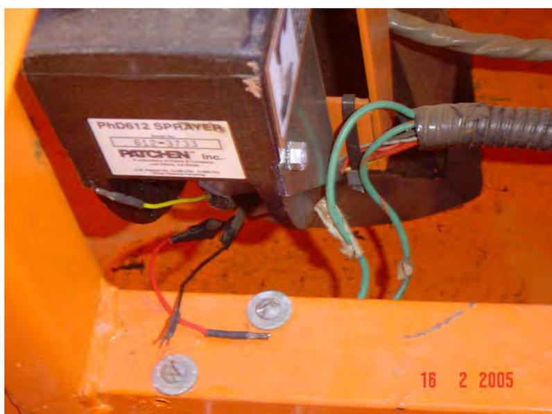
Figura 35. Desconexão dos fios responsáveis por enviar sinais elétricos às válvulas solenóides.
