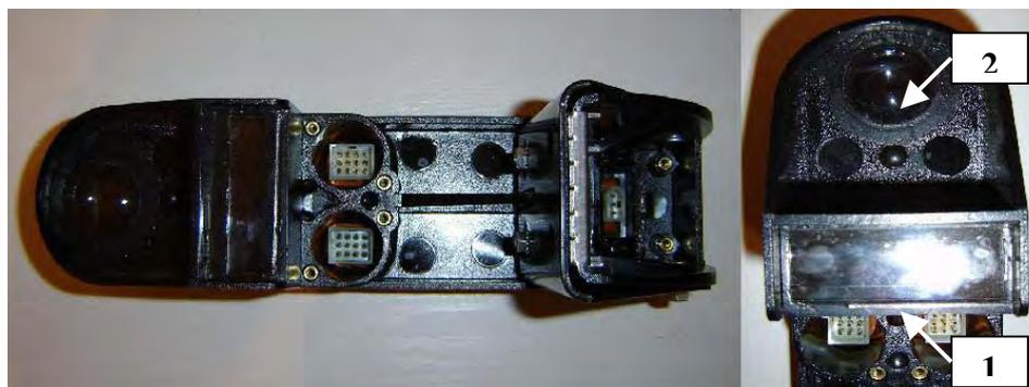
Figura 15. Visão da parte inferior do sensor óptico. 1 – Fonte de emissão de luz; 2 – Detector de luz refletida pela planta.
