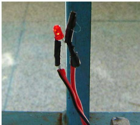
Figura 25. LED ligado ao sistema e responsável pela indicação de detecção de planta.
