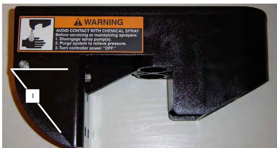
Figura 30. Composição estrutural do sensor: 1 - local que permite a fixação do sensor, revestido por metal.
