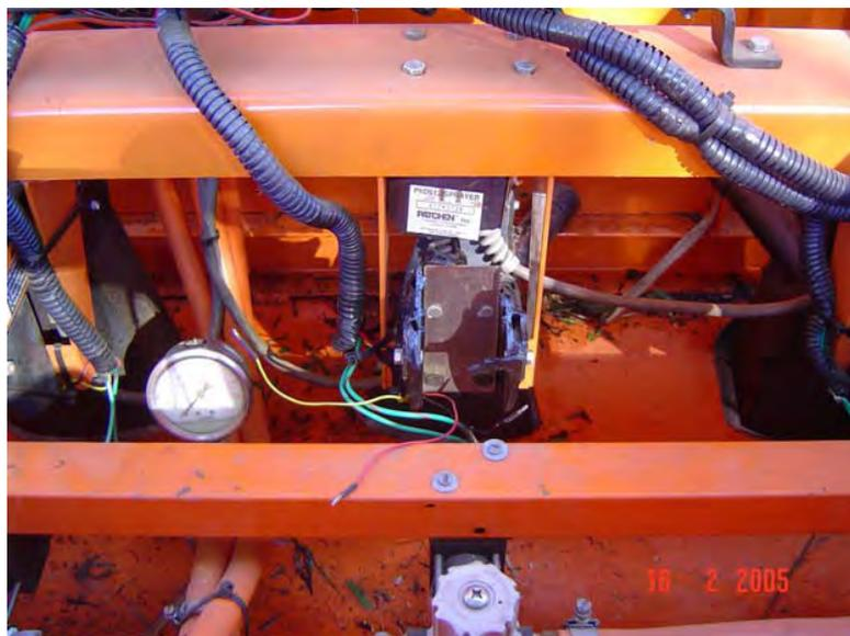
Figura 33. Quebra do sensor em função dos impactos decorrentes do deslocamento do conjunto trator-pulverizador.
