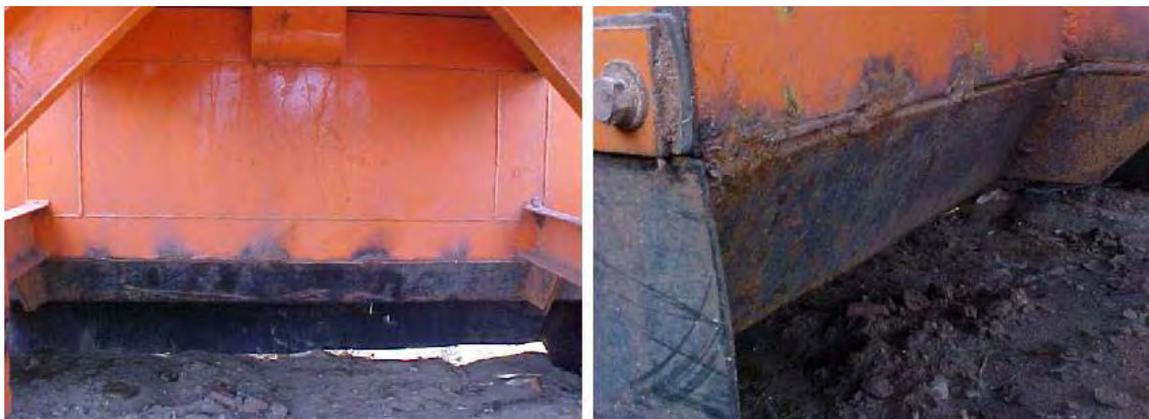
Figura 37. Anteparo soldado na posição diagonal à parte de trás da caixa metálica protetora.
