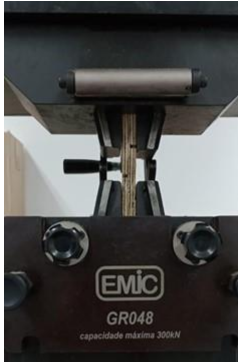
Figura 30: Ensaio de cisalhamento na linha de cola
