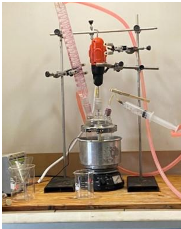
Figura 17: Reator para confecção do adesivo
