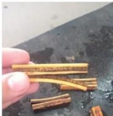
Figura 32: Delaminação do corpo de prova
