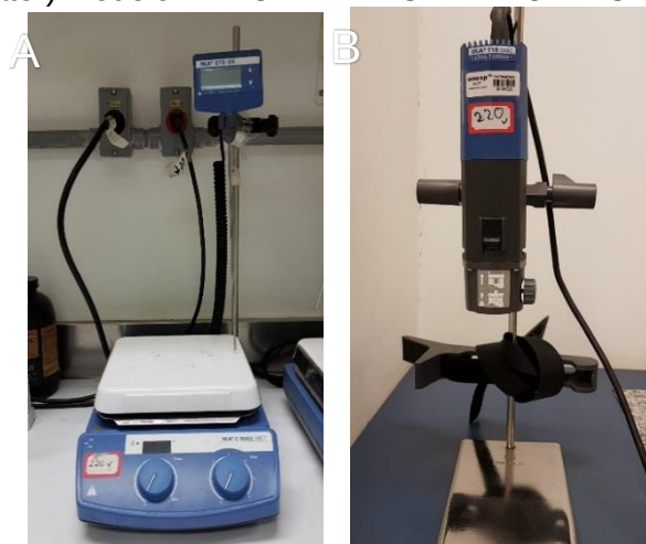
Figura 10 - (A) Agitador magnético e (B) Dispensador do tipo mecânico (rotor estator) modelo IKA ULTRA-TURRAX® T 18 basic
