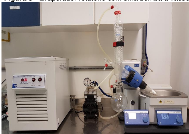
Figura 8 - Evaporador rotatório com uma bomba a vácuo
