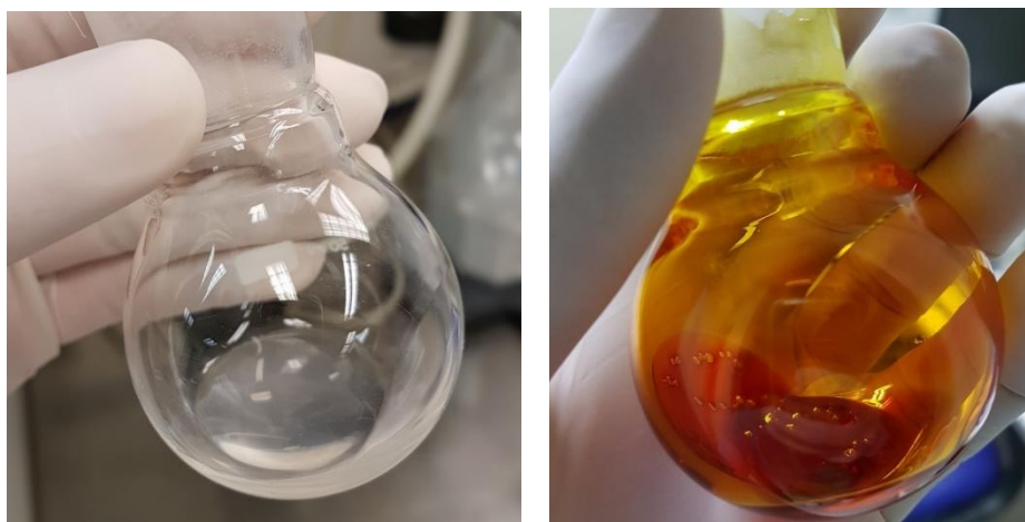
Figura 9 - Evaporação total do clorofórmio no fundo do balão indicando formação de filme polimérico
