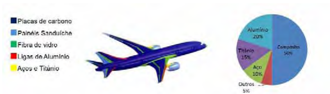
Figura 2.2 – Tipos de materiais empregados na aeronave Boeing 787 (KAWASAKI HEAVY INDUSTRIES, 2012).
