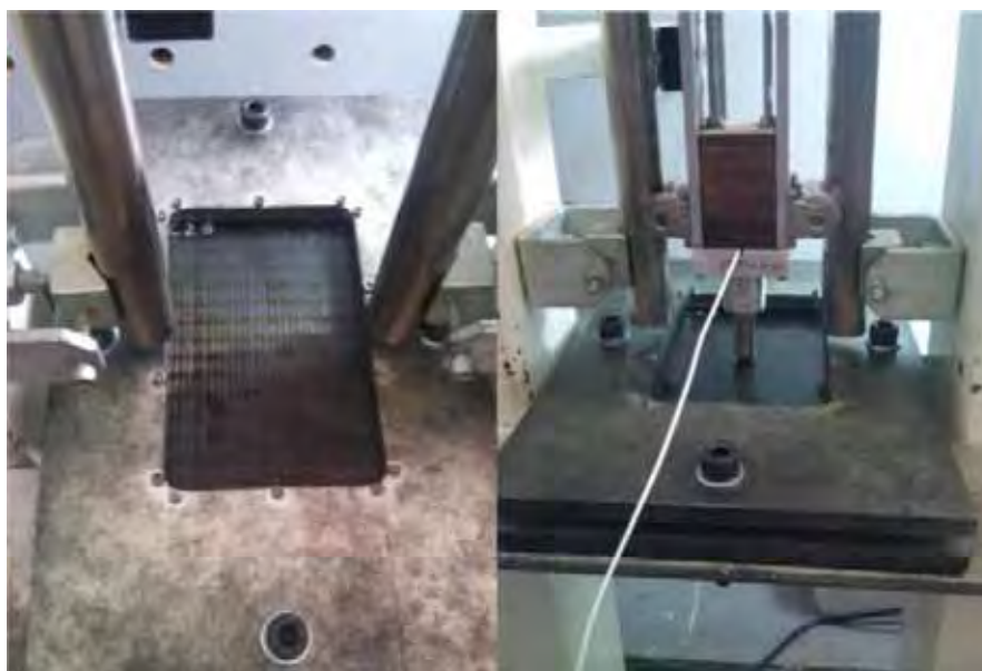
Figura 4.17 – Montagem do corpo de prova na máquina de ensaio vista do momento do impacto.
