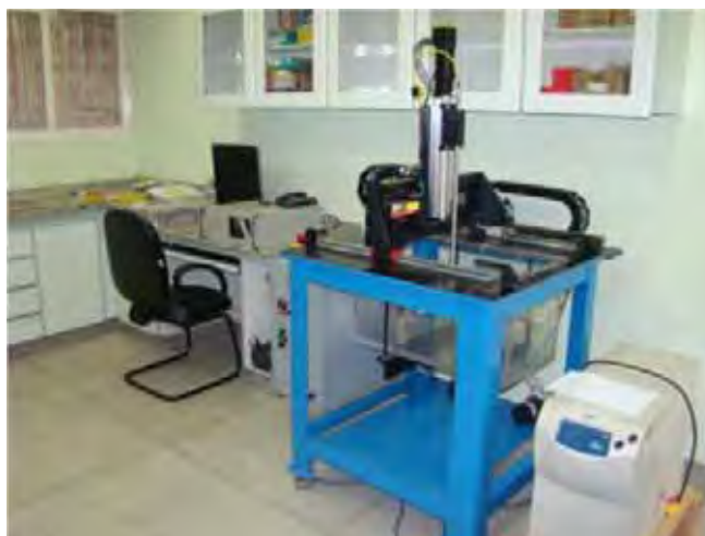
Figura 4.8 – Equipamento de inspeção acústica C-Scan utilizado.
