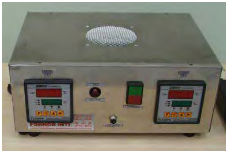
Figura 4.2 - Controlador de temperatura utilizado no molde RTM.
