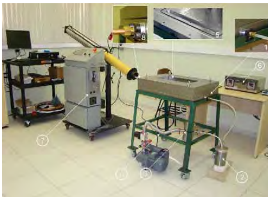
Figura 4.3 - Sistema de processamento via RTM do Grupo de Pesquisa em Fadiga e Materiais Aeronáuticos da FEG/UNESP.
