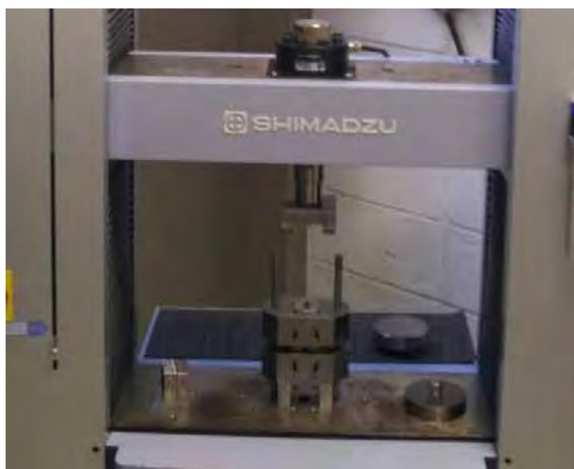
Figura 4.14 - Equipamento de ensaio universal marca SHIMADZU utilizado.
