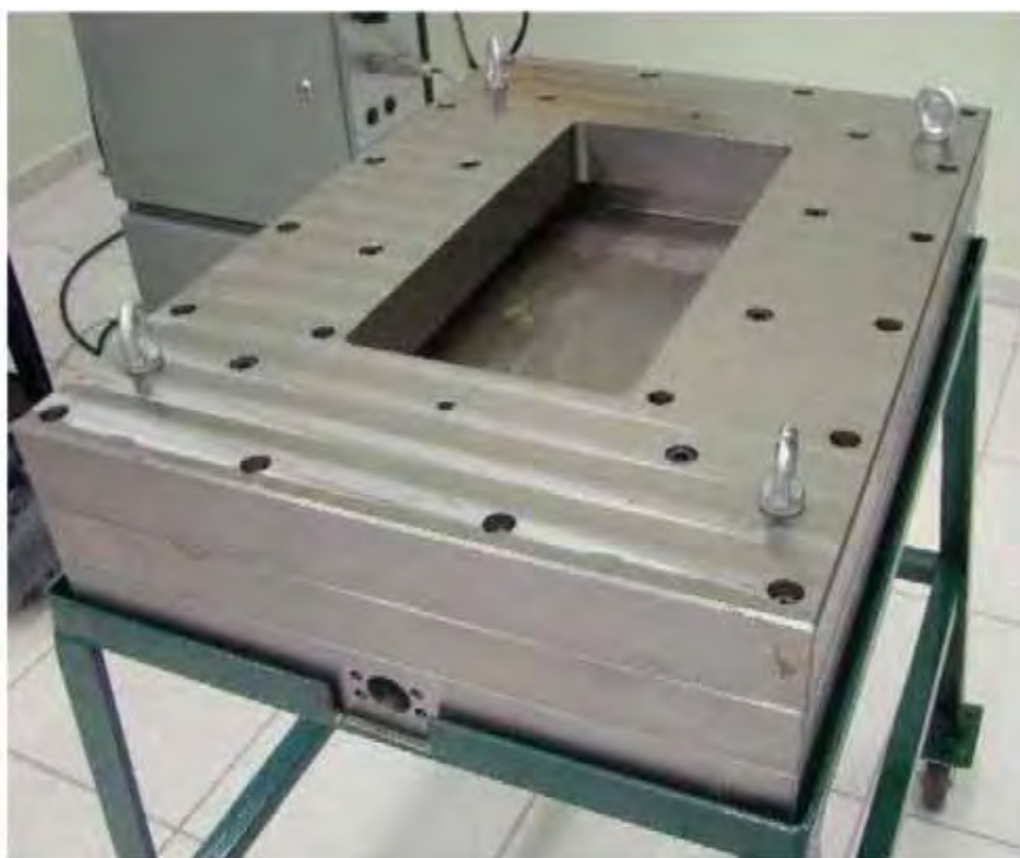
Figura 4.1 - Molde do processo RTM confeccionado em AISI 1045, utilizado neste estudo.
