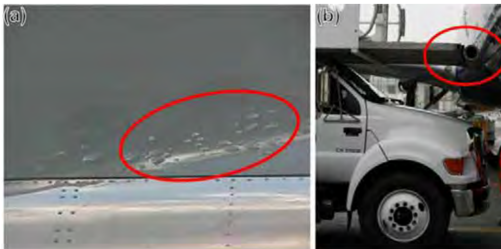
Figura 2.11 – (a) Resultado de impacto de chuva de granizo em um bordo de ataque. (b) Colisão de veículo de apoio com uma aeronave, resultado de uma manobra mal sucedida durante a operação em solo (FAWCETT, ALLEN J.; OAKES, GARY D.).
