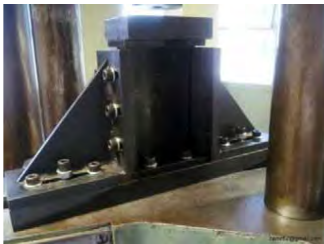
Figura 5.17 – Ensaio de compressão após impacto de acordo com ASTM D 7137/7137M.
