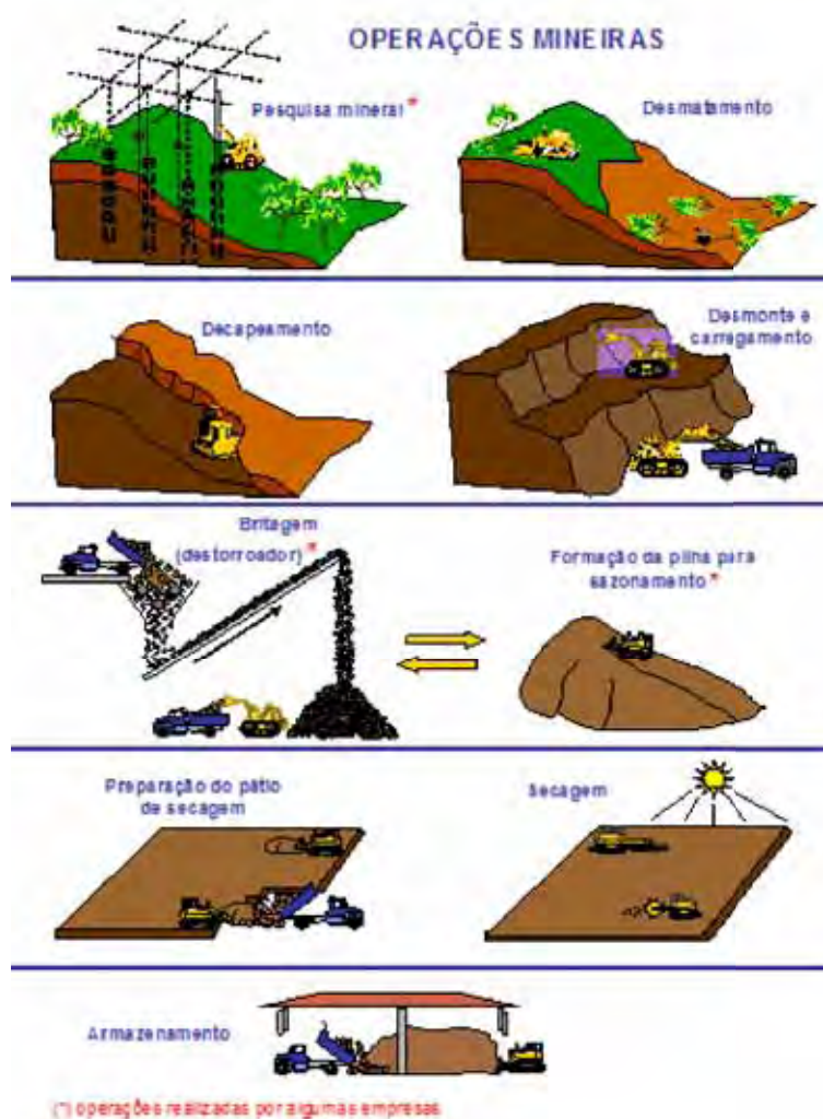
Figura 15: Principais operações para obtenção das massas cerâmicas pelo processo via seca (Fonte: Adaptado de IPT, 2002)
