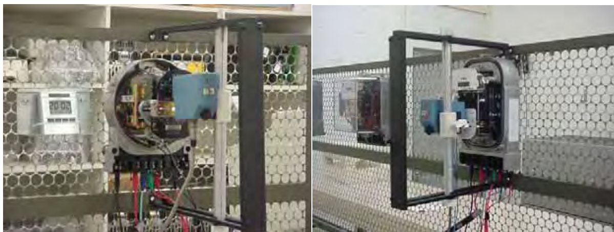
Figura 3.97 – Sensor de voltas de disco para medidores tipo indução.
