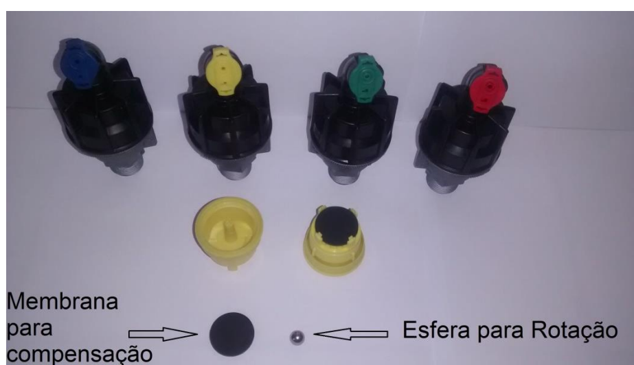
Figura 2. Detalhe dos aspersores com bocais de quatro cores, esfera que provoca rotação por ação centrífuga e membrana compensadora de pressão.
