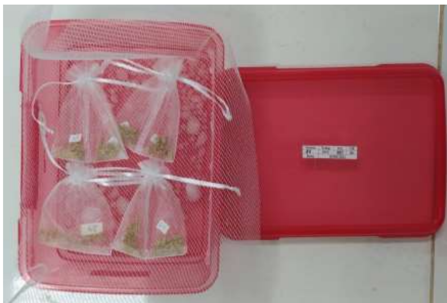
Figura 1 - Caixa hermética com solução saturada de KCl e suporte para os sacos com as sementes
