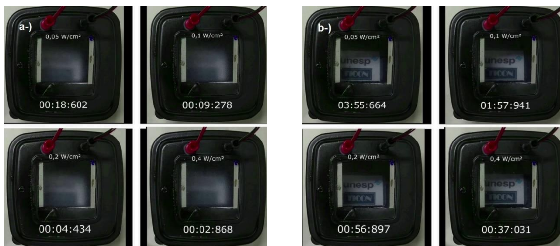
Figura 15 – Exemplo da medida com a Câmara de Orvalho, em diferentes potências. a-) Antes. b-) Depois do desembaçamento. Fonte: Elaborado pelo autor.
