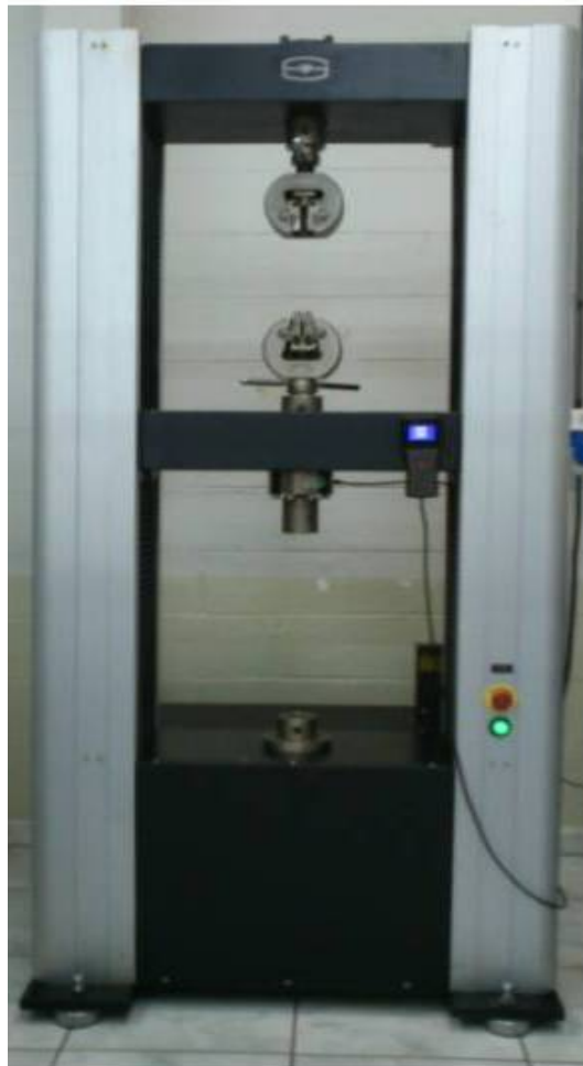
Figura 3.12 – Máquina de ensaios mecânicos WDW100EB 100KN (imagem do próprio autor)
