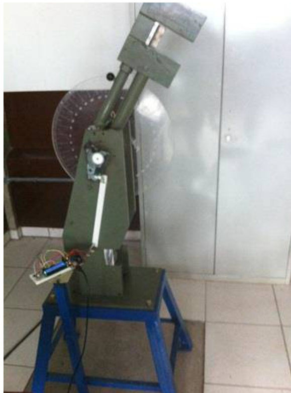
Figura 2.40 – Kit arduino e kit do encoder fixados na máquina (imagem do próprio autor)
