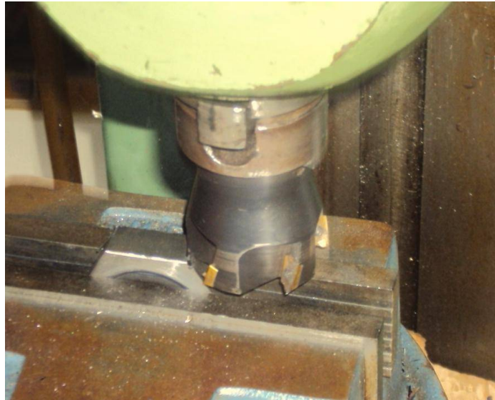
Figura 2.4 – Fresando a Porca de sustentação
