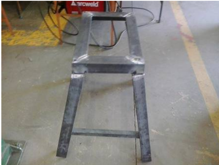
Figura 2.26 - Apoio do Charpy soldado (imagem do próprio autor)
