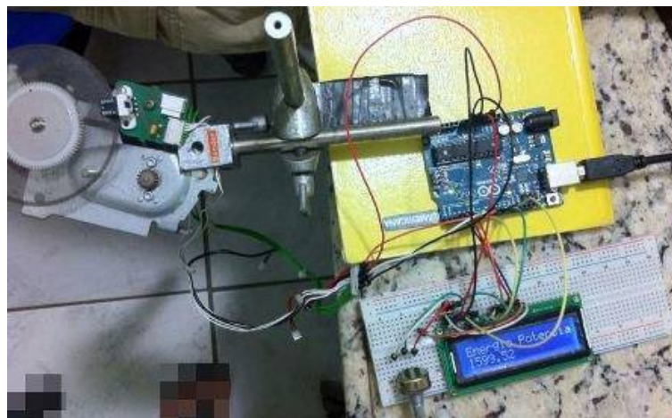
Figura 2.38 – Teste feito no arduíno e encoder (imagem do próprio autor)
