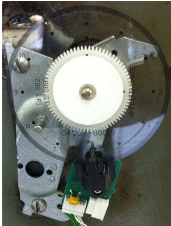
Figura 2.36 – Kit com encoder e o disco (imagem do próprio autor)
