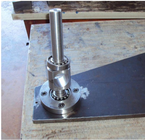
Figura 2.15 – Eixo de Giro sendo Montado
