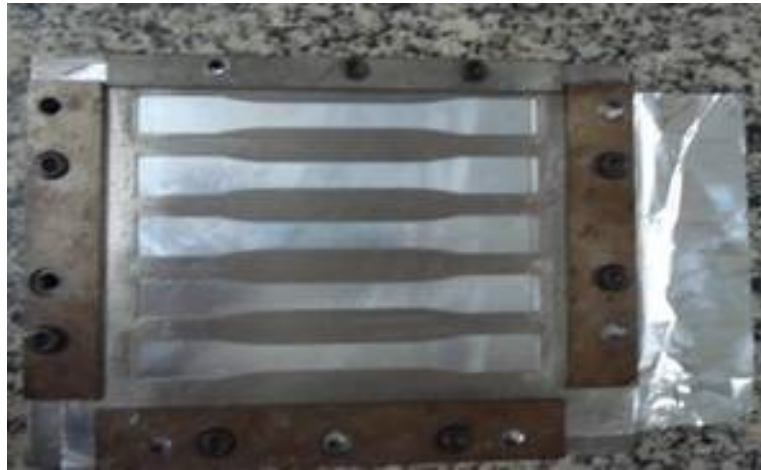
Figura 1.40 – Molde para a preparação dos corpos de prova, ensaio de tração
