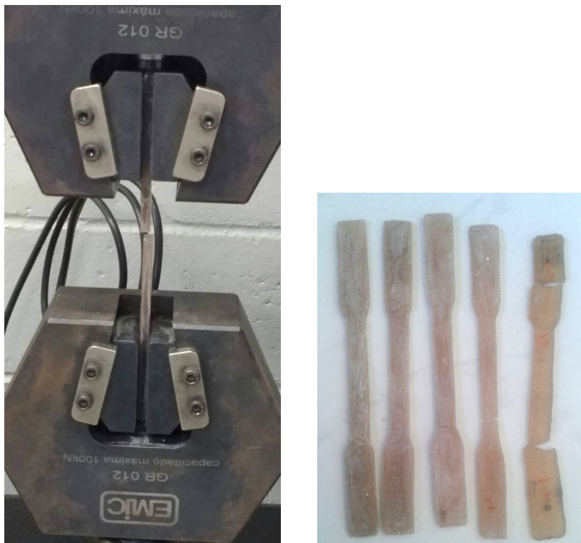
Figura 3.14 – Corpos de prova nos ensaios – Resina pura (imagem do próprio autor)
