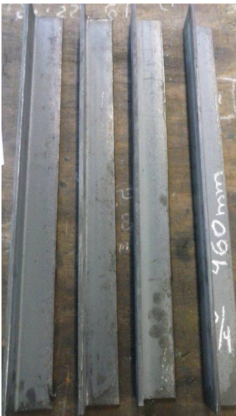
Figura 2.25 - Peças perfil L cortadas pelo processo de corte por serra fita (imagem do próprio autor)
