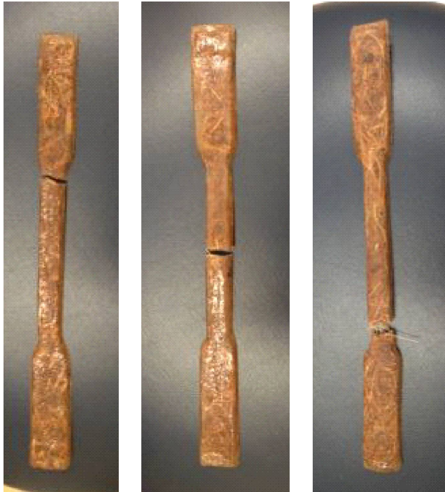
Figura 3.16 – Corpos de prova depois dos ensaios – Fibra de coco (imagem do próprio autor)
