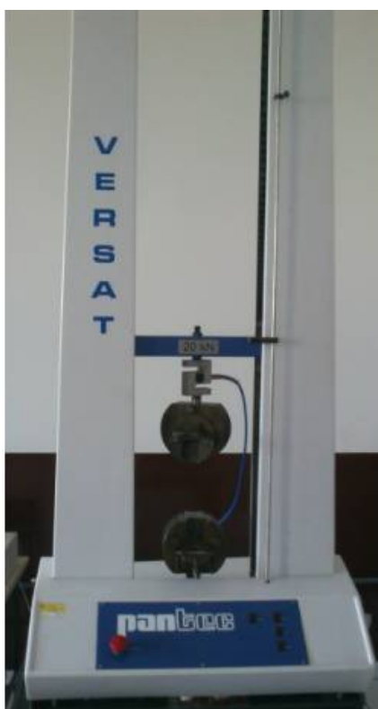
Figura 1.31 – Máquina de ensaio de tração universal Fonte: Autoria própria
