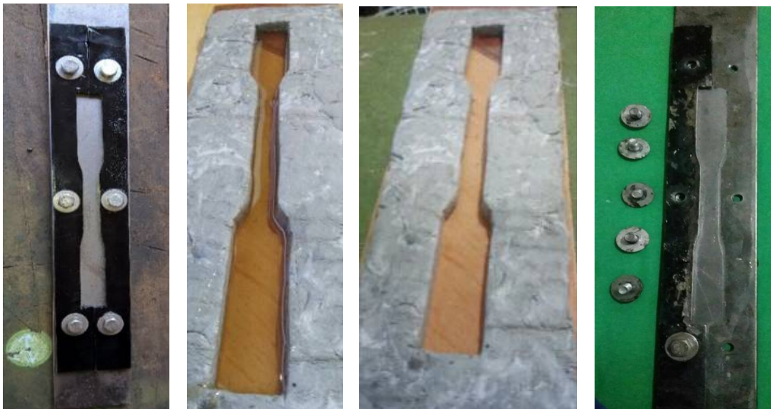
Figura 3.2 – Moldes para confeccionamento dos CP's (imagem do próprio autor)
