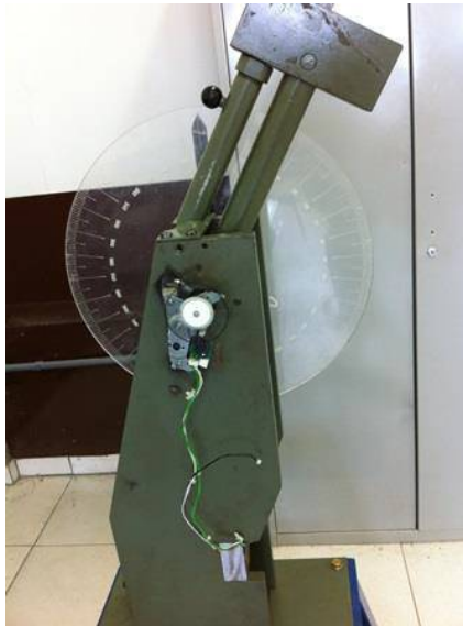
Figura 2.39 – Montagem do encoder e disco no eixo da máquina pendular (imagem do próprio autor)
