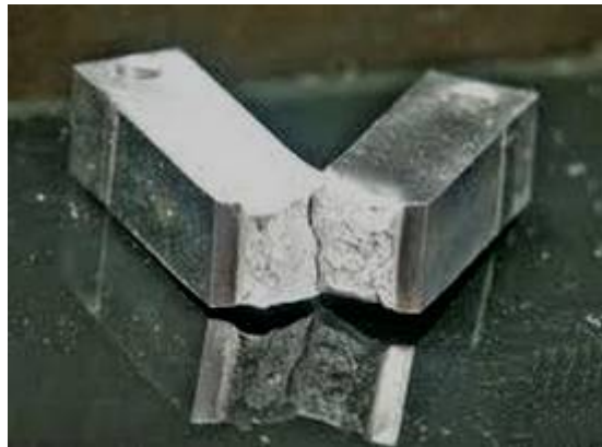
Figura A.12 – Exemplo de corpo de prova de alumínio rompido pelo ensaio Charpy
