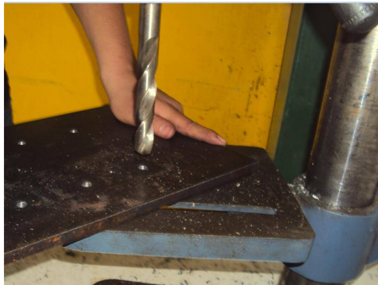
Figura 2.8 – Base de Apoio
