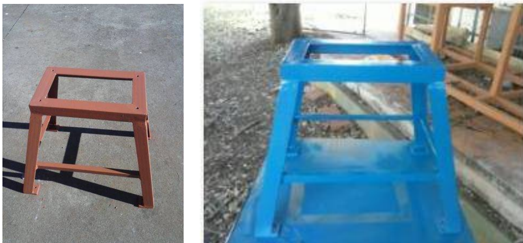
Figura 2.27 – Pintura anti-ferrugem (esquerda) e Definitiva (direita)
