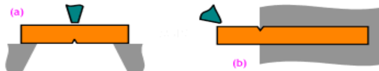
Figura 1.13 – Apoios dos corpos de prova no ensaio Charpy (MSPC – Inf. Tec.)
