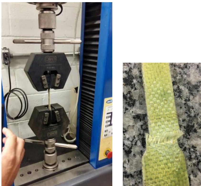
Figura 3.15 – Corpos de prova depois dos ensaios – Fibra de Kevlar (imagem do próprio autor)
