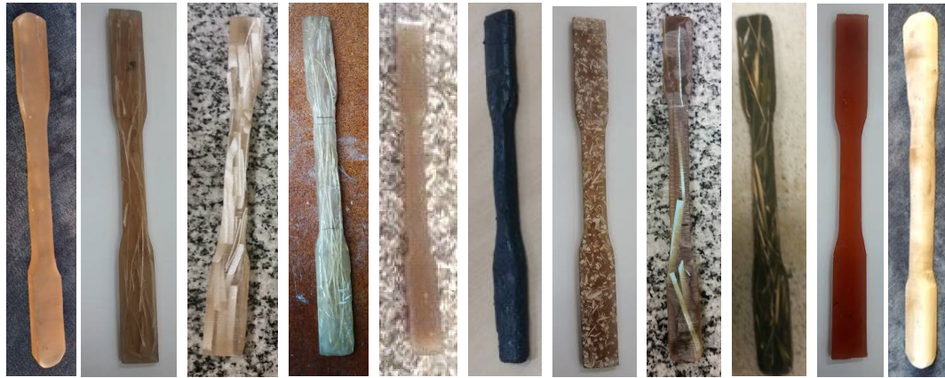
Figura 3.7 – Corpos de prova diversos (Sem Fibra, Fibra de Bambu, Nylon, Coco, Cana e outros) (imagem do próprio autor)
