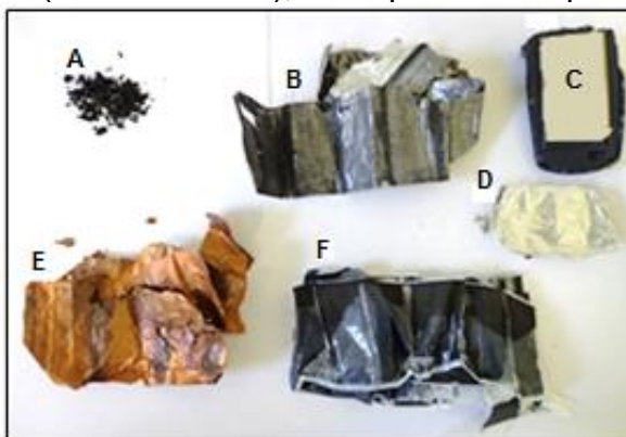
Figura 16 - Componentes de uma Bateria de Li- íon polímero: A - Material ativo; B - Coletor de carga Cátodo (folha de Alumínio); C - Plástico externo; D - Blindagem; E - Coletor de carga ânodo (folha de cobre); F - Separador de plástico.
