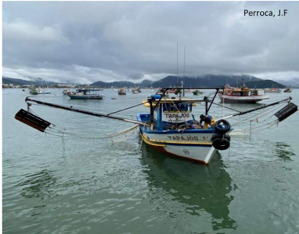
Figura 2 – Barco camaroeiro equipado com redes de arrasto duplo, utilizados para as amostragens do presente estudo.
