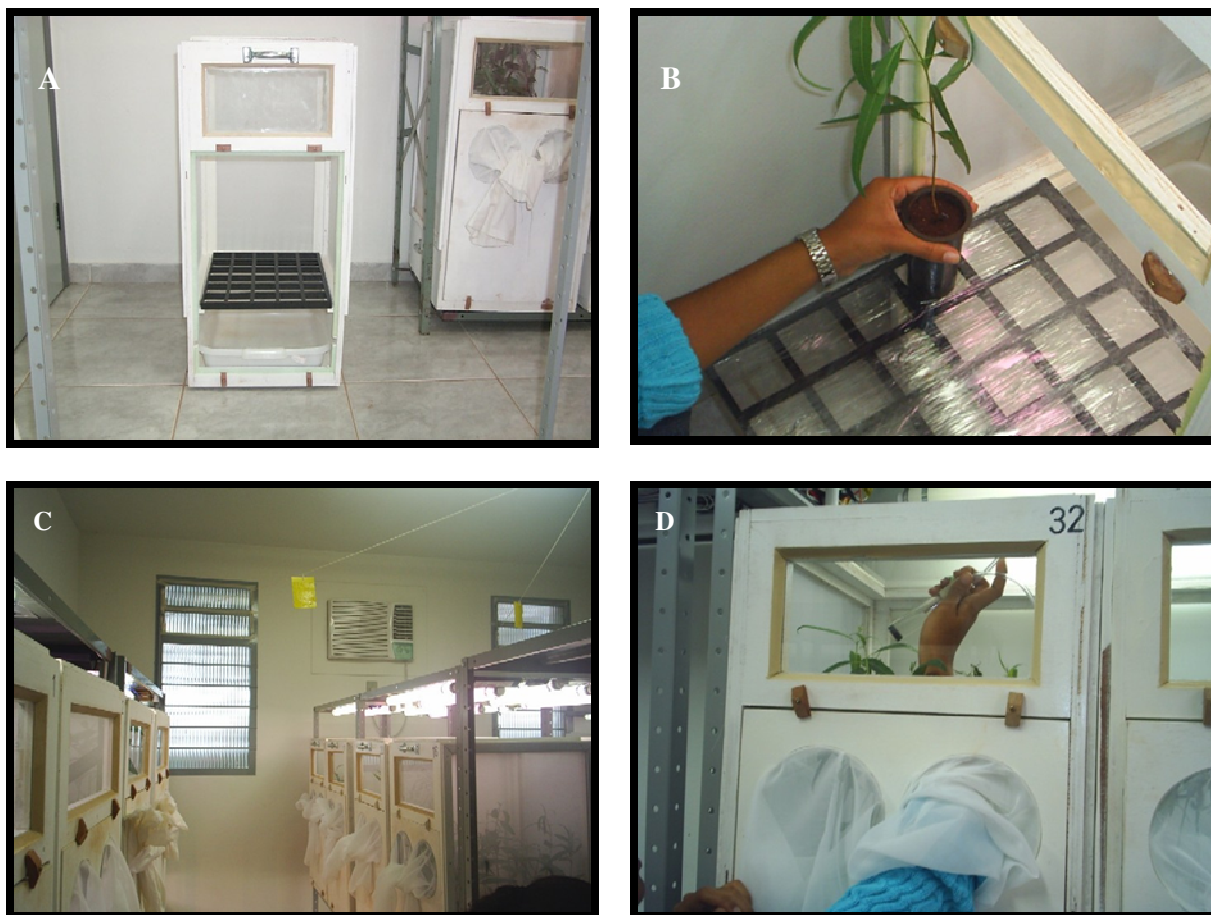
Figura 1. Vista geral da gaiola (A), colocação da muda de eucalipto na bandeja (B), disposição das gaiolas nas prateleiras da sala de criação (C) e manejo dos insetos adultos no interior das gaiolas (D).
