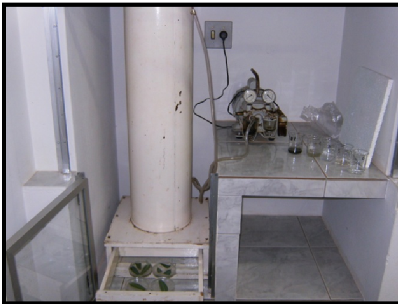
Figura 3. Torre de Potter adaptada para aplicação dos bioinseticidas.
