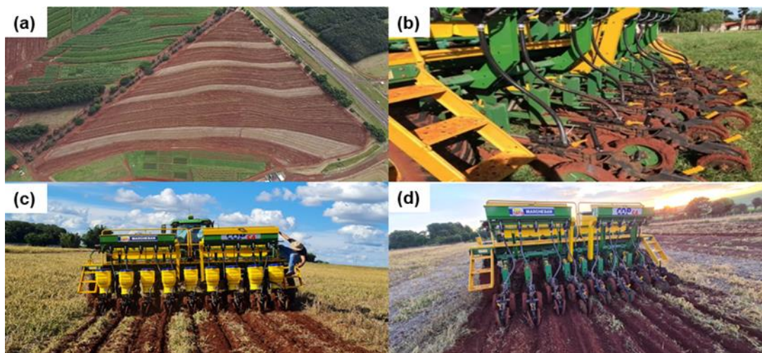
Figura 7. Semeadura das plantas de cobertura, vista aérea após a semeadura (a), adaptações feitas para semeadura de sementes pequenas (b), semeadura do tremoço com sistema de distribuição convencional (c) e sistema de distribuição de sementes pequenas acoplado na barra porta ferramentas (d). Ribeirão Preto, Estado de São Paulo, Brasil.
