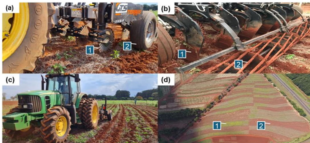
Figura 3. Equipamento utilizado no preparo subsolado vista frontal (a) e seus componentes: disco ondulado de corte (a1), roda de controle de profundidade (a2), vista traseira (b), haste subsoladora (a1), rolo destorroador (a2), trator utilizado para tracionar subsolador (c), vista aérea da área de estudo (d), sem nenhum preparo (d1) e após preparo com subsolador (d). Ribeirão Preto, Estado de São Paulo, Brasil.
