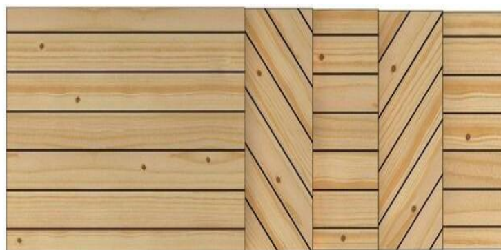
Figura 22 – Esquema da configuração de um painel MLCC desenvolvido por Buck e Hagman com camadas de 45° e 90° intercaladas com camadas a 0°.
