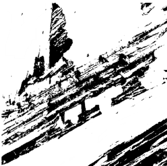
Figura 38 – Imagem segmentada da linha de cola após aplicação do Threshold com o método de Otsu.
