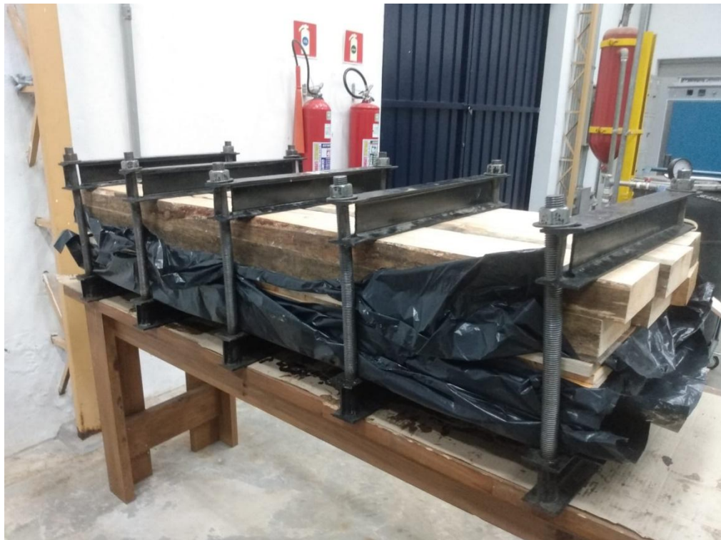
Figura 32 – Processo de prensagem dos painéis de MLCC, utilizando barras roscadas, chapas metálicas e vigas de madeira para distribuição uniforme da pressão.
