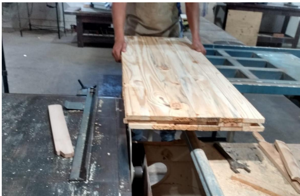
Figura 33 – Processo de esquadrejamento dos painéis de MLCC utilizando serra circular para ajuste dimensional e acabamento final.
