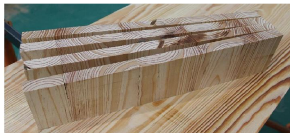
Figura 23 – Protótipo do painel MLCC desenvolvido por Santos: (a) Lamelas cruzadas; (b) Camada híbrida de montagem de camada cruzada; (c) Painel de 3 camadas
