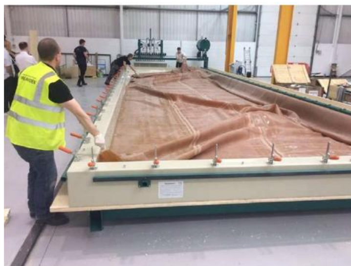
Figura 11 – Prensa a vácuo por membrana flexível.
