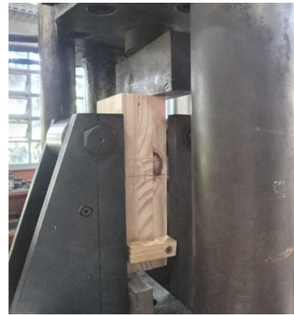
Figura 43 – Configurações do ensaio de cisalhamento vertical: (a) Geometria e dimensões do corpo de prova; (b) Hastes de madeira parafusadas às lamelas externas; (c) Instrumentação do ensaio, com transdutores de deslocamento apoiados nas hastes e fixados lateralmente; (d) Arranjo experimental do corpo de prova na máquina de ensaios
