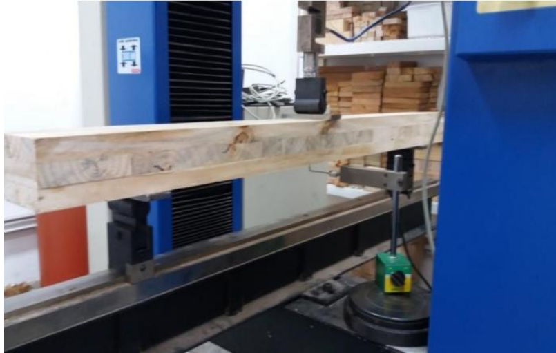
Figura 39 – Configuração do ensaio de vão variável para corpo de prova P90.
