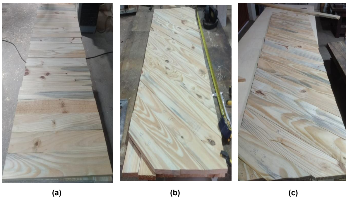
Figura 30 – Gabarito de seccionamento das lamelas da camada central do MLCC para painéis com camada central: (a) 90^\circ ; (b) 45^\circ ; (c) 30^\circ .
