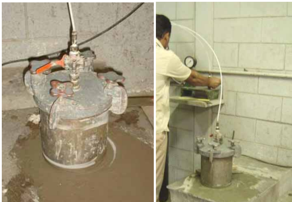
Figuras 18 – Aparelho (de pressão) que mede a quantidade de ar incorporado.
