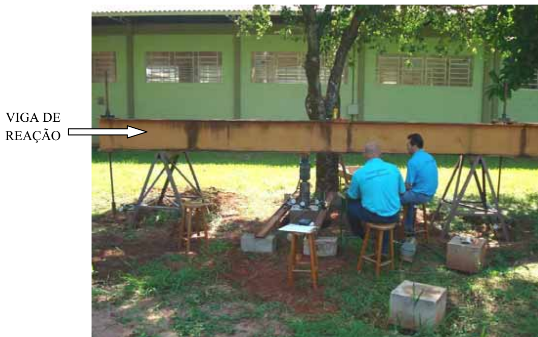
Figura 41 – Início do ensaio; equipamentos e viga de reação instalados para o ensaio.
