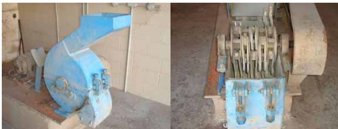
Figura 9 – Britador de facas do Laboratório CESP de Engenharia Civil.
