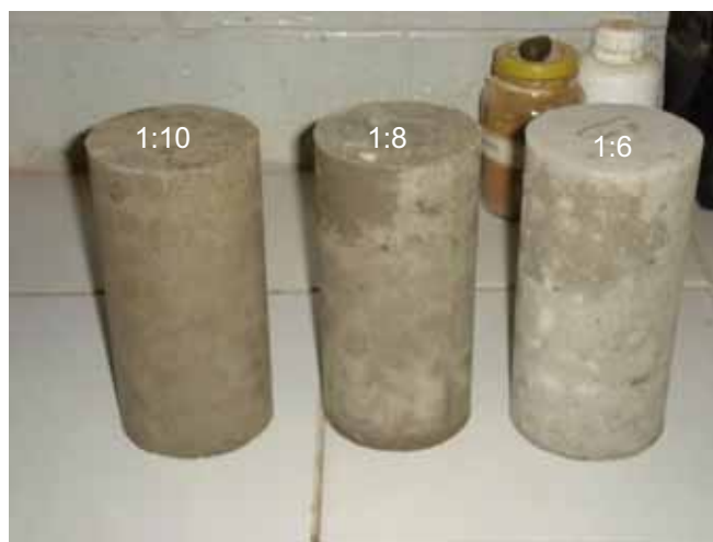
Figura 15 – Corpos-de-prova moldados para o estudo de dosagem - traços 1:10, 1:8 e 1:6.
