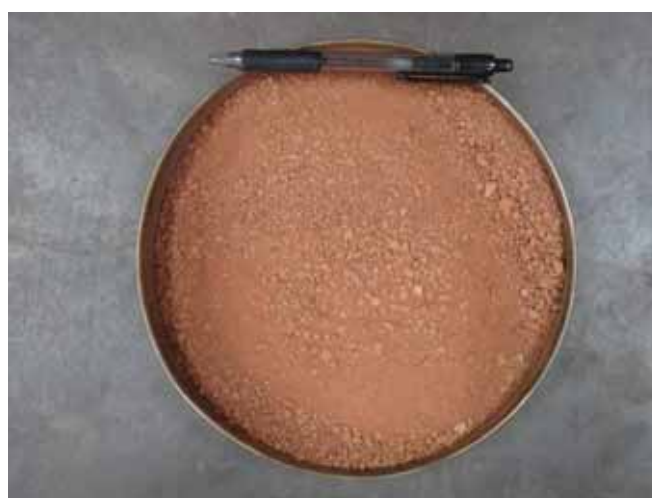
Figura 10 – Agregado miúdo artificial (cerâmica vermelha) triturado.
