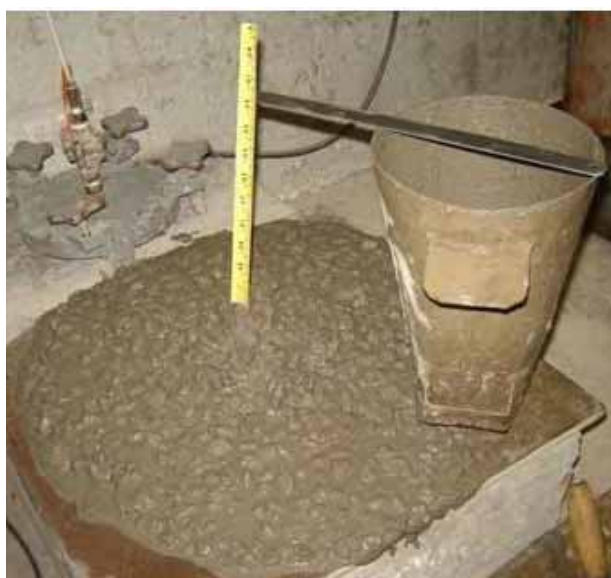
Figura 17 – Ensaio de abatimento ( Slump Test ).
