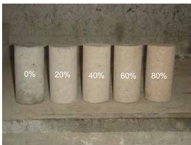
Figura 16 – Coloração dos corpos-de-prova com os diferentes teores de substituição.
