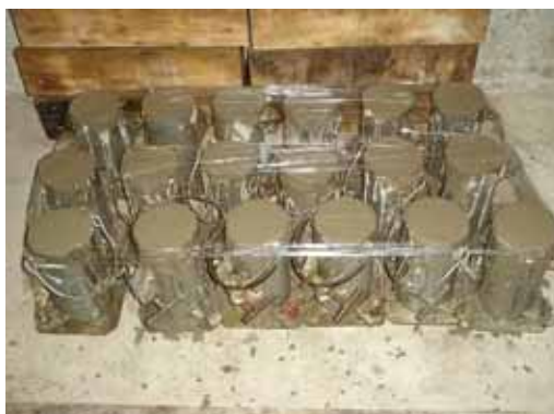
Figura 20 - Moldagem dos corpos-de-prova.
