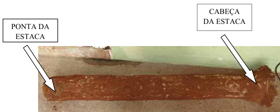
Figura 29 – Mini-estaca retirada do campo para ser ensaiada.
