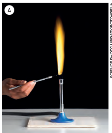
Teste da chama com o elemento sódio.
