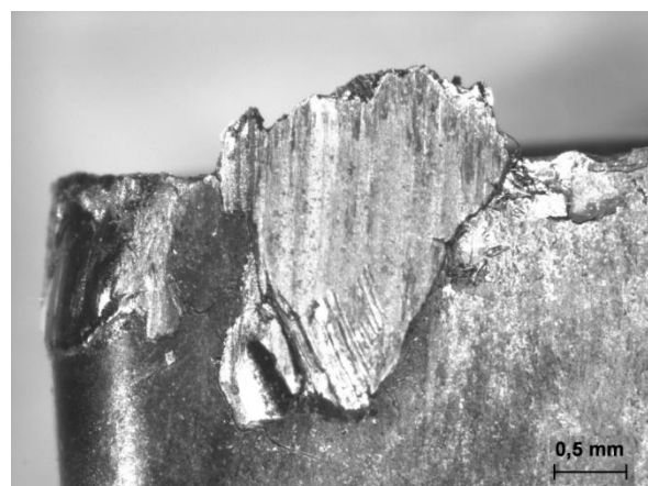
Figura 5.70 – Desgaste de ferramentas ( V_c = 150 m/min) MQL.
