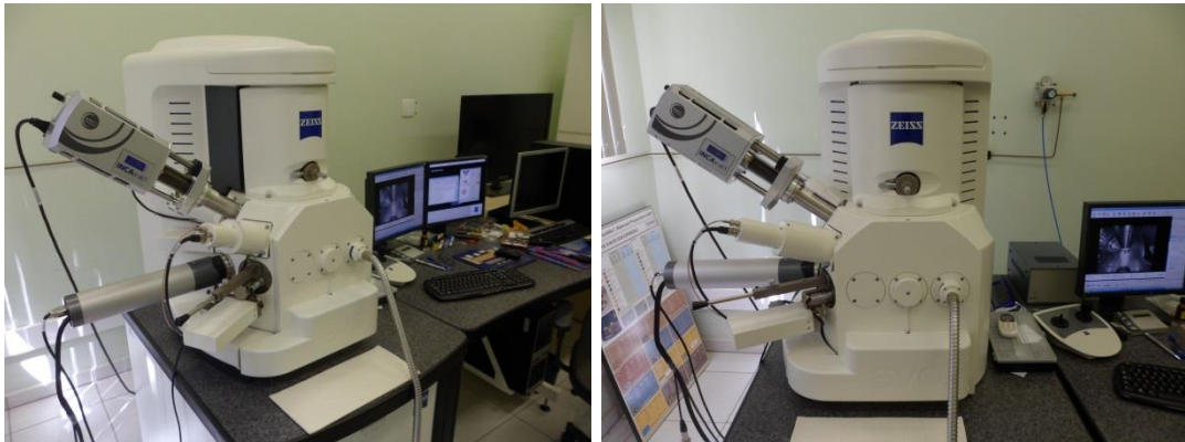
Figura 4.13 - Microscópio Eletrônico de Varredura Zeiss, modelo EVO LS15
