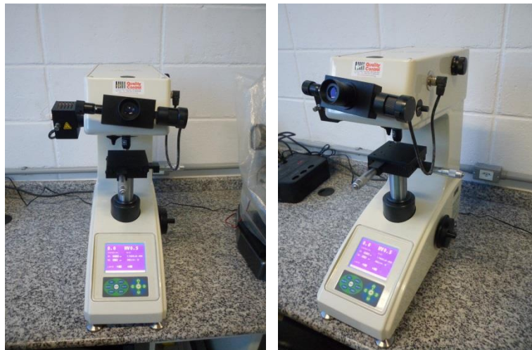
Figura 4.11 – Microdurômetro Wilson® Instruments, modelo 401 MVD.
