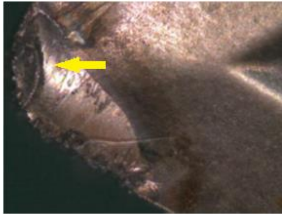
Figura 3.13 - Desgaste de cratera em uma ferramenta de metal duro sem recobrimento na usinagem do Nimonic 80A – v_c = 90 m/min., f = 0,18 mm/rot. e a_p = 1,6 mm.
