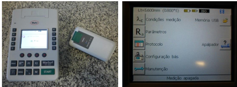
Figura 4.8 - Rugosímetro Mahr modelo MarSurf M300 e MarSurf RD 18
