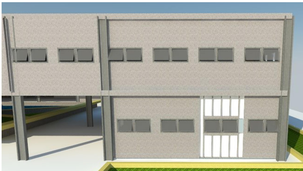
Figura 71- Detalhe das placas cimentícias.
