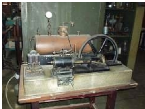
Figura 45 - Máquina a vapor – caldeira ao fundo e mecanismo em primeiro plano. Versão adaptada (RIO DE JANEIRO, 2013, não paginado)
