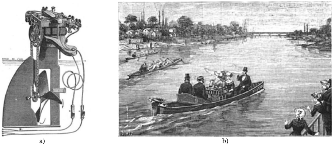
Figura 1 - Primeiro motor de popa (a) e primeira aplicação prática (b).
