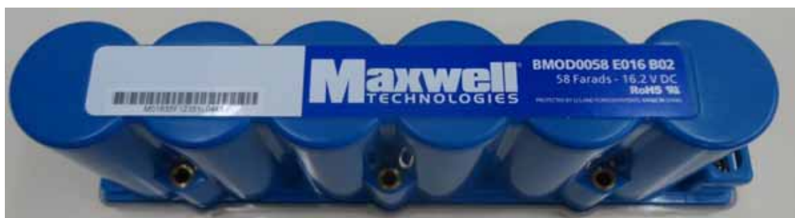
Figura 117 - Módulo integrante do banco de supercapacitores.
