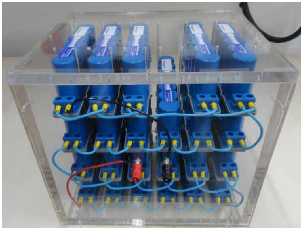
Figura 118 - Banco de Supercapacitores.
