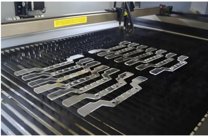
Figura 21 —peças obtidas através de corte a laser . Adaptado de Bruscato & alii (2014: 11)
