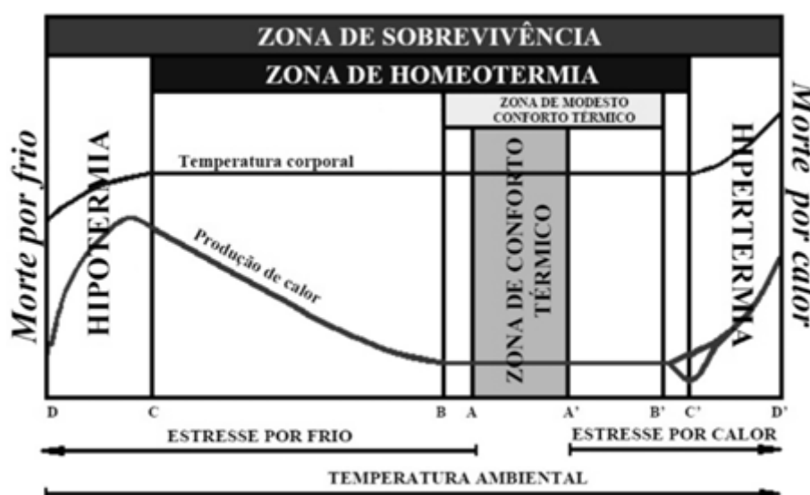
Figura 2 - Diagrama de temperatura da zona de conforto térmico
