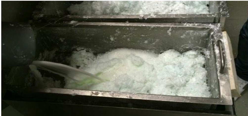
Figura 24 - Resíduos de resina e policarbonato misturados com água
