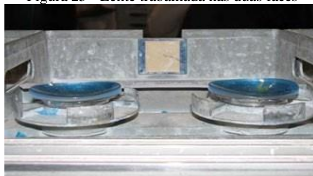
Figura 25 - Lente trabalhada nas duas faces
