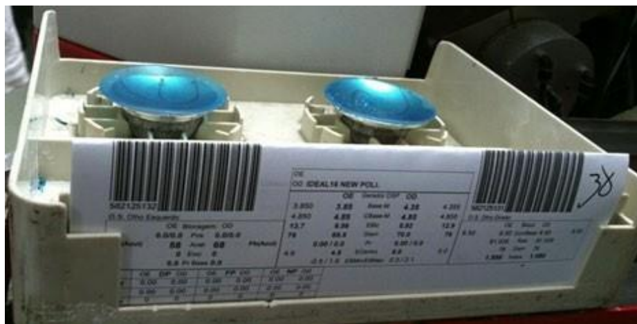
Figura 23 - Lente desgastada, com a dioptria indicada pelo código de barras
