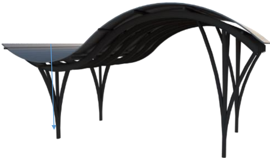
Figura 47 – Estrutura metálica e telha sanduíche
