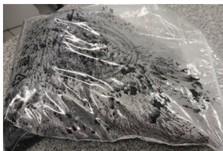
Figura 11 – Fotografia de compósito com lama embalado mostrando a retenção de água.
