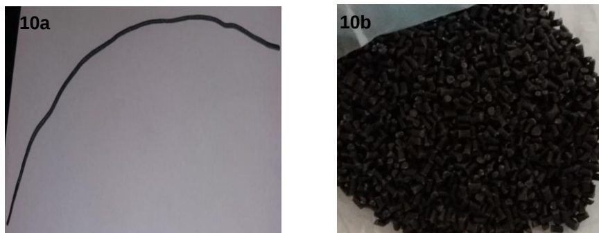
Figura 10 – (a) Filamento da proporção 90% HIPS e 10% fibra resina (% em gramas) e (b) Pellets de Poliestireno de alto impacto (HIPS) pós-consumo com carga
