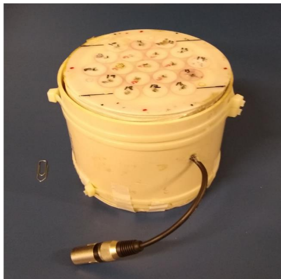
Figura 3.1 – Imagens dos sensores BAC reais utilizados nesse trabalho. Em (A) temos o sensor do Sistema BAC Mono Canal, composto por 1 par de bobinas de excitação e 1 par de bobinas de detecção e em (B) temos o sensor Sistema BAC Multi Canal 19, composto por 1 par de bobinas de excitação e 19 pares de bobinas de detecção.
