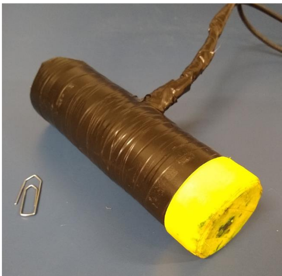
Figura 3.1 – Imagens dos sensores BAC reais utilizados nesse trabalho. Em (A) temos o sensor do Sistema BAC Mono Canal, composto por 1 par de bobinas de excitação e 1 par de bobinas de detecção e em (B) temos o sensor Sistema BAC Multi Canal 19, composto por 1 par de bobinas de excitação e 19 pares de bobinas de detecção.
