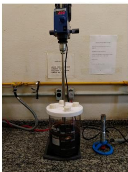
Figura 5. Cultivo do mutante MEL1 (etapa da cultura) em reator de tanque agitado com impelidor náutico.
